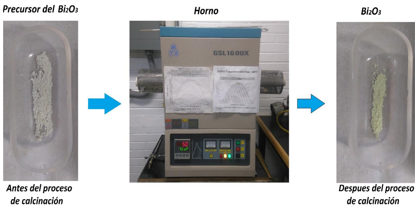
Figura 3.3 Proceso de calcinación de los precursores para su transformación a \alpha - \text{Bi}_2\text{O}_3 .
