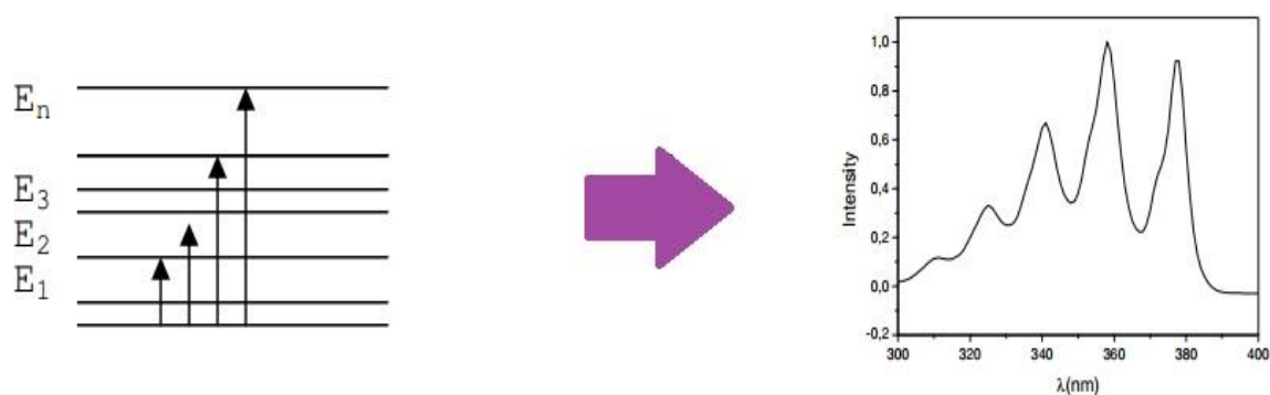
Figura 2.6 Esquema de la generación de un espectro de absorción característico.
