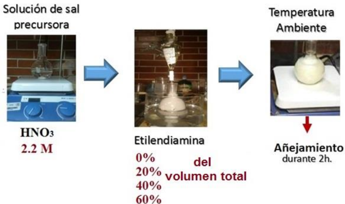
Figura 3.1 Proceso de precipitación química.
