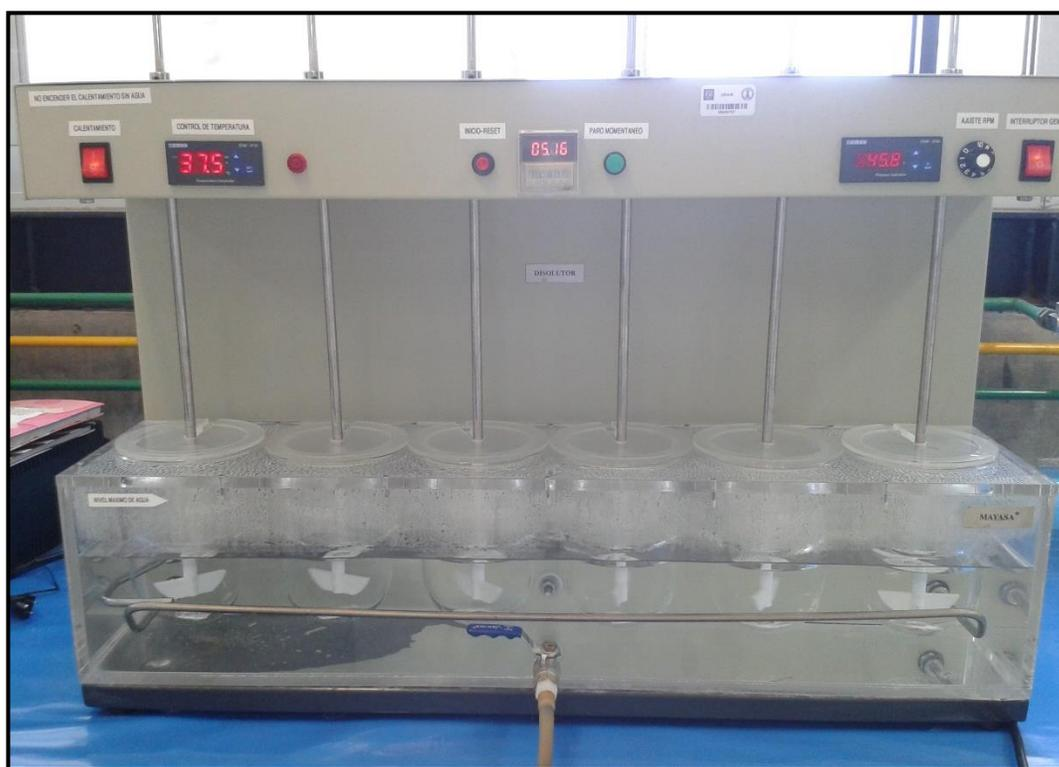
**Ilustración 25.** Disolutor MAYASA, utilizado en la prueba de liberación de dexametasona para el parche transdérmico tipo reservorio.
