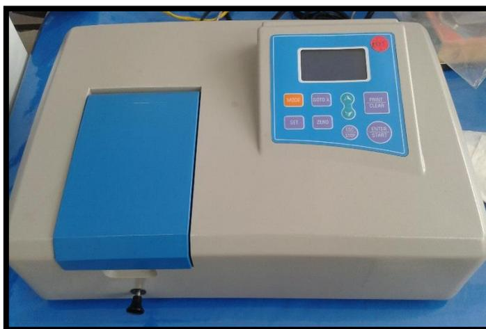
**Ilustración 24. Espectrofotómetro**, utilizado en el desarrollo del método analítico para contenido químico.
