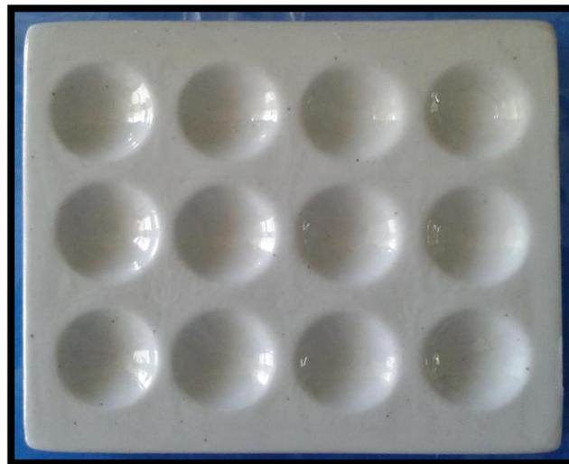
**Ilustración 18.** Placa de porcelana. Utilizada como molde para la obtención de la placa impermeable y formación del reservorio.
