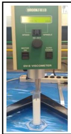
**Ilustración 23. Viscosímetro,** utilizado en la medición de la viscosidad para la muestra de gel cargado con dexametasona.
