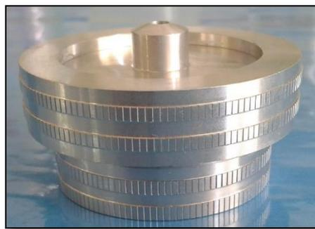
**Ilustración 22. Picnómetro metálico.** Con este material fue determinada la densidad relativa para la muestra de gel con dexametasona.
