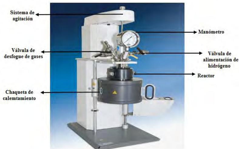
Figura 20. Sistema de hidrotratamiento [17].
