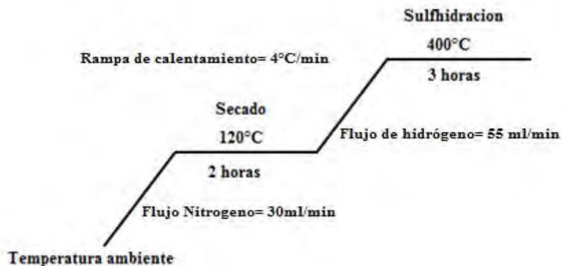
Figura 17. Esquema del proceso de sulfhidración del catalizador.
