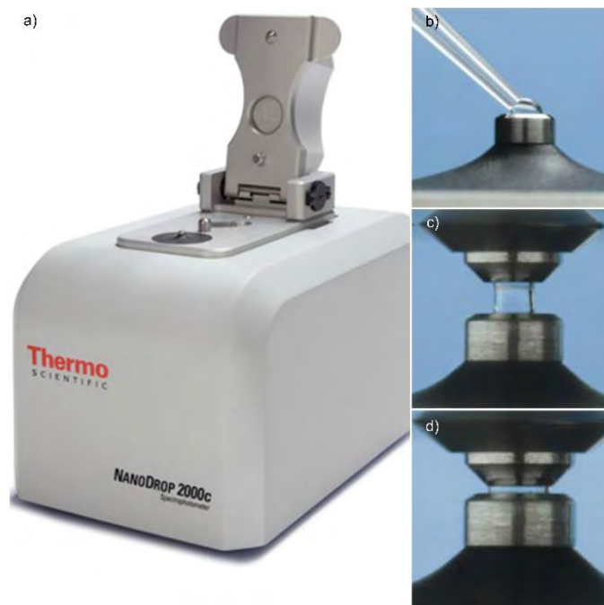
Figura 19. a) Equipo de espectrofotometría comercial NanoDrop 2000c de Thermo Scientific, b) detalle mostrando la forma en que se carga la muestra en el pedestal del NanoDrop, c) y d) procedimiento automático para lectura de muestra [74]).
