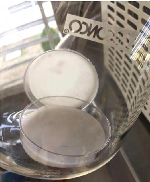
Figura 9. Muestras PVA/CHX en vasos para liofilizar. Fuente propia
