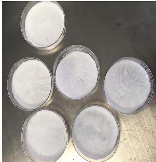
Figura 10. Matrices PVA/CHX liofilizadas. Fuente propia
