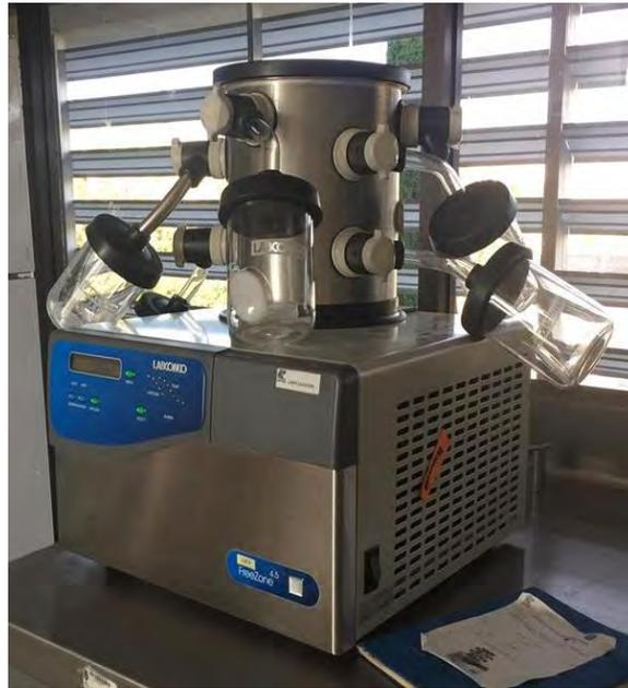
Figura 4. Liofilizadora labconco. Fuente propia
