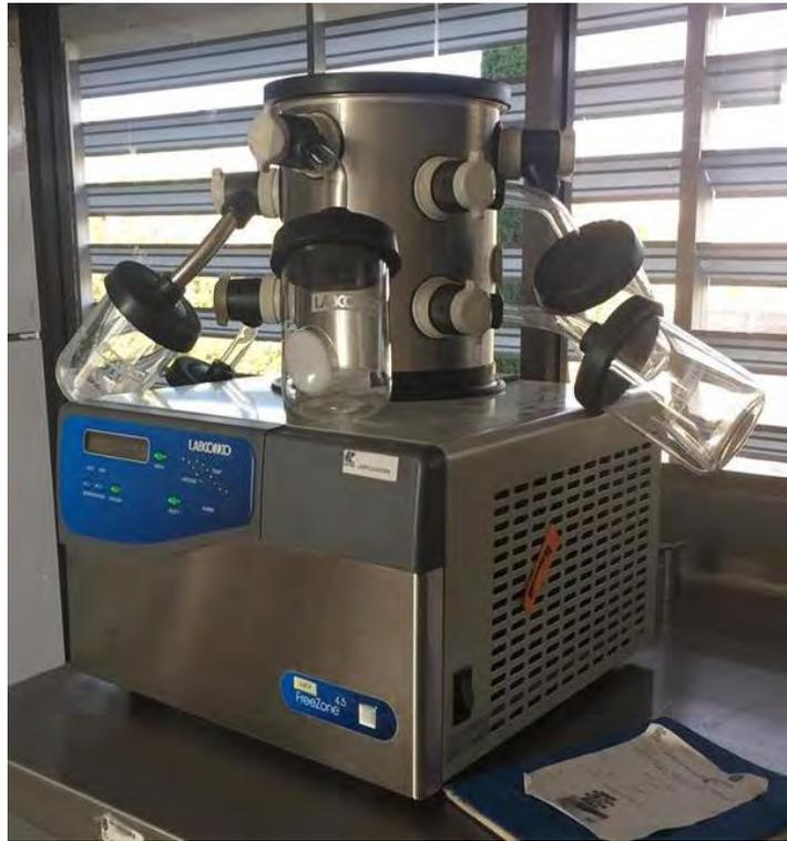
Figura 8. Liofilizadora labconco con vasos. Fuente propia
