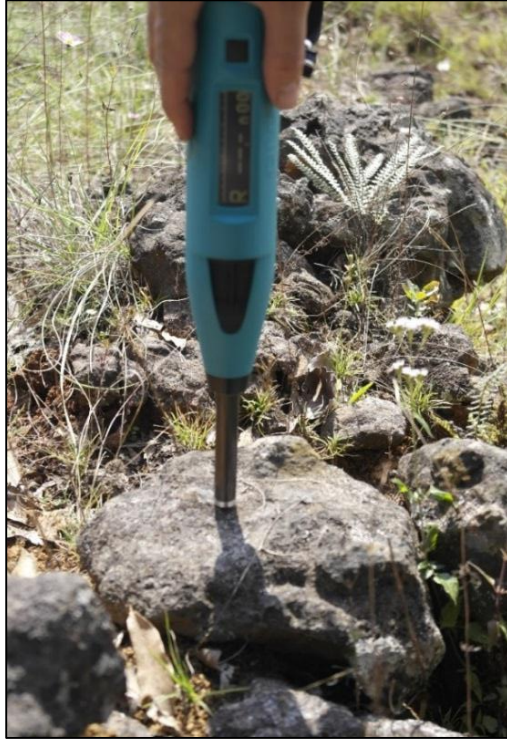
Figura 3.4 Ensayo sobre roca en Huasca de Ocampo. Nótese que el valor R fue de 0.
