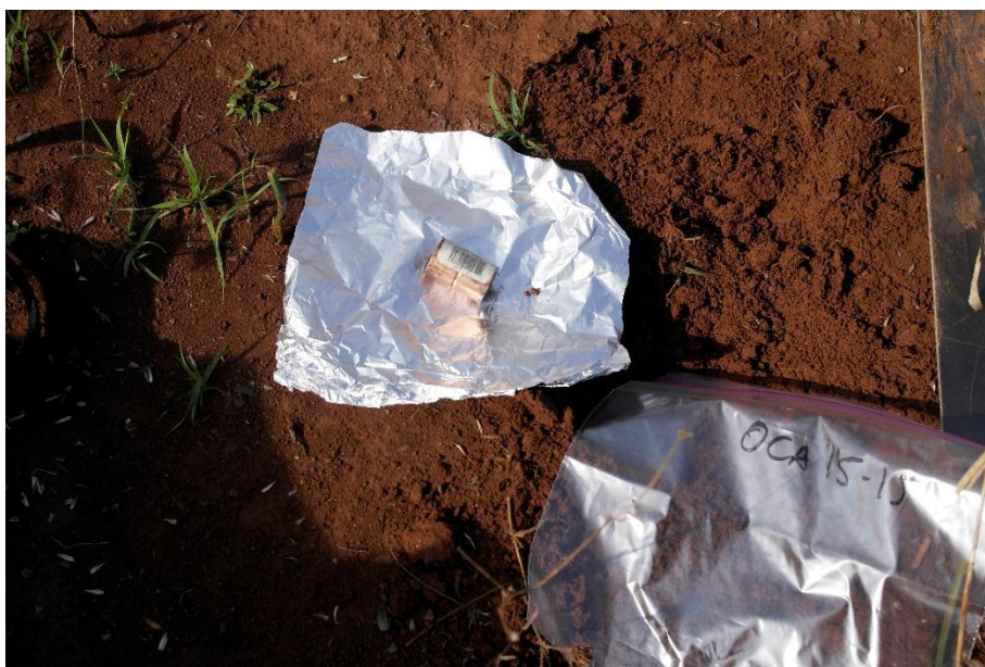
Figura 3.9 Tubo de cobre y papel aluminio para la colecta de muestra de OSL, Huasca de Ocampo, 2016.
