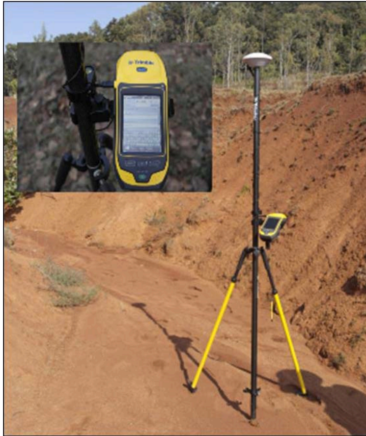
Figura 3.1 Instalación del GPS de doble frecuencia en el fondo de una cárcava en Huasca de Ocampo, Hidalgo, 2016.
