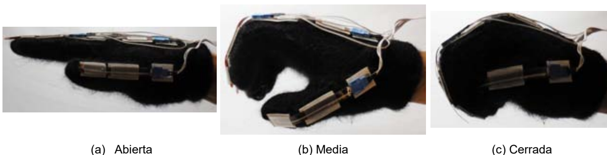
Fig. 7.13 Definición de las posiciones del guante y sus límites de voltaje asociados.
