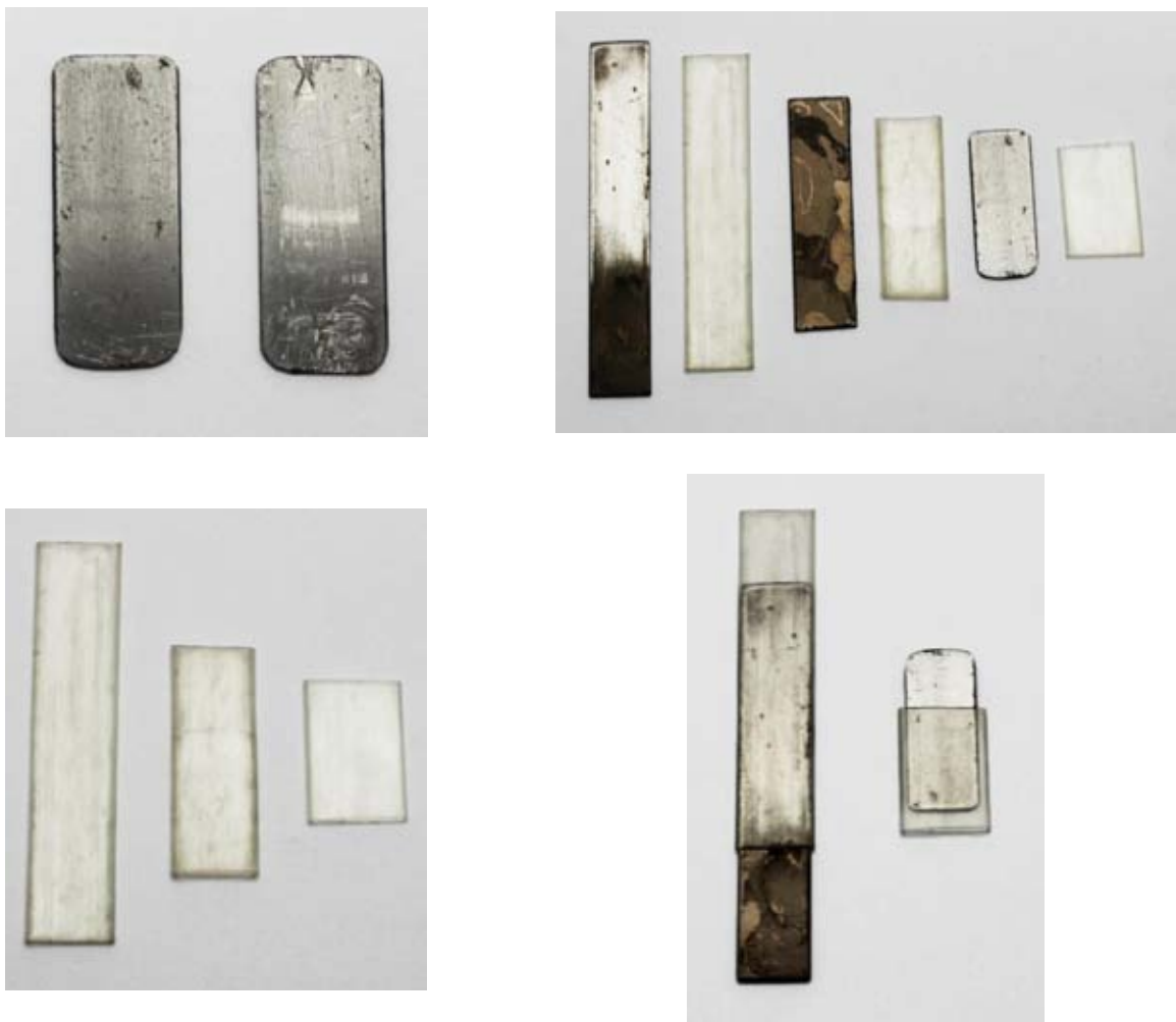
Figura 6.13 Bases y guías utilizadas para montar los sensores de flexión en el guante.
