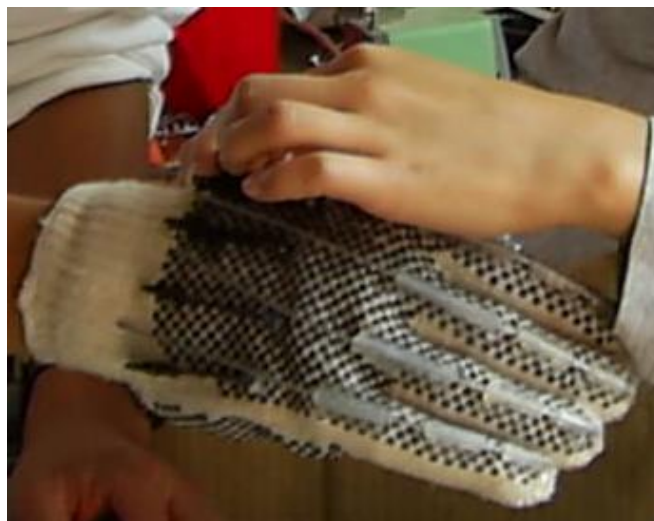
Figura 6.6 Colocación de potenciómetros sobre los huesos metacarpianos de los dedos en el guante.
