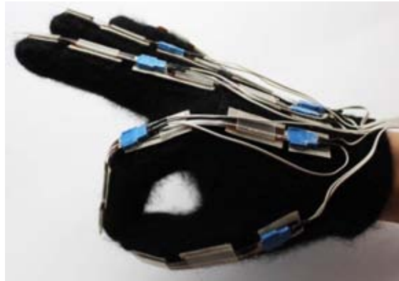
Figura 7.5 Tercer prototipo del guante con sistema sensorial.
