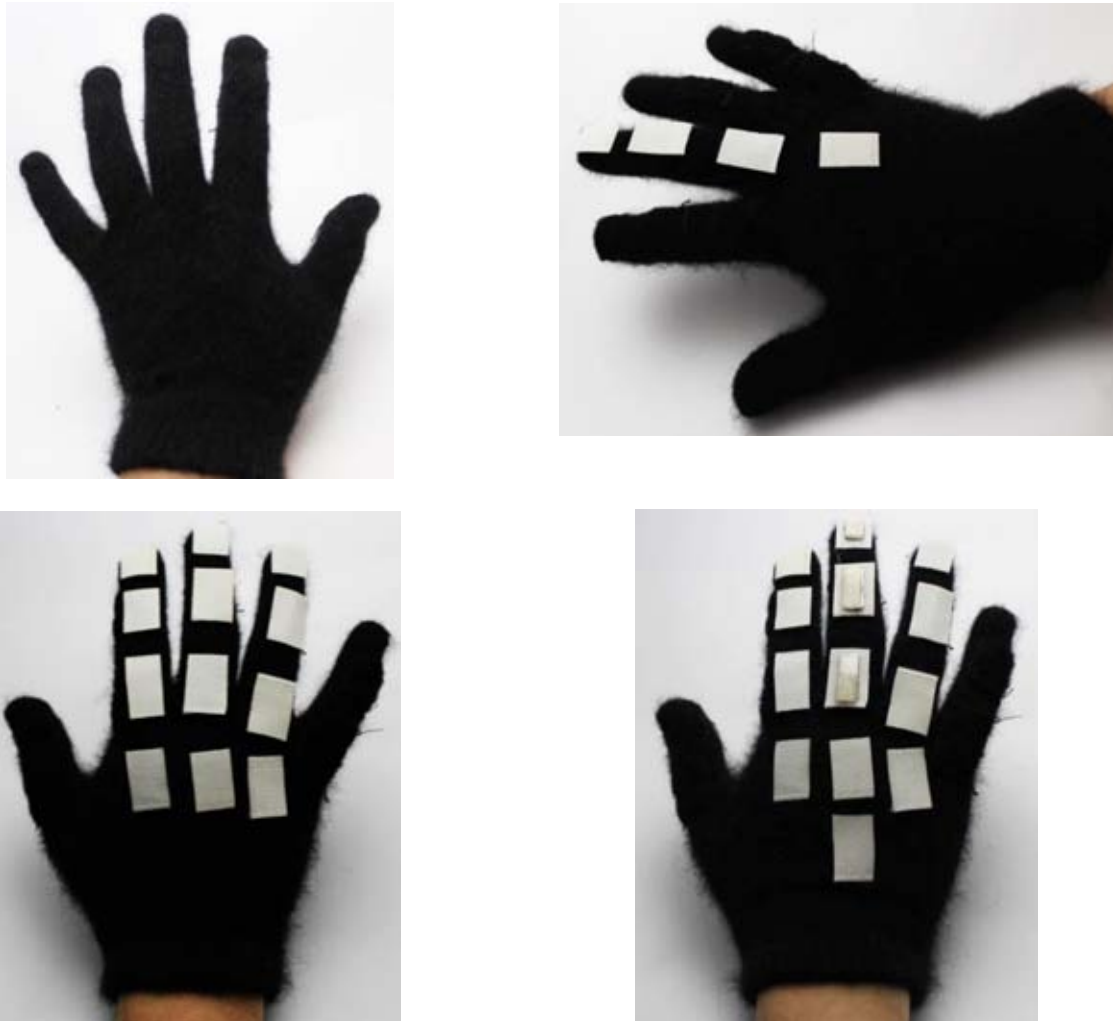
Figura 6.14 Colocación de trozos de velcro en el guante de estambre previo a la fijación de las bases y los sensores.
