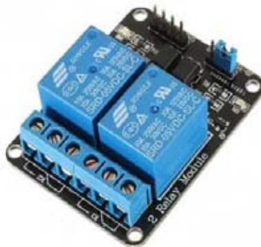
Figura 16. Módulo de relevadores
