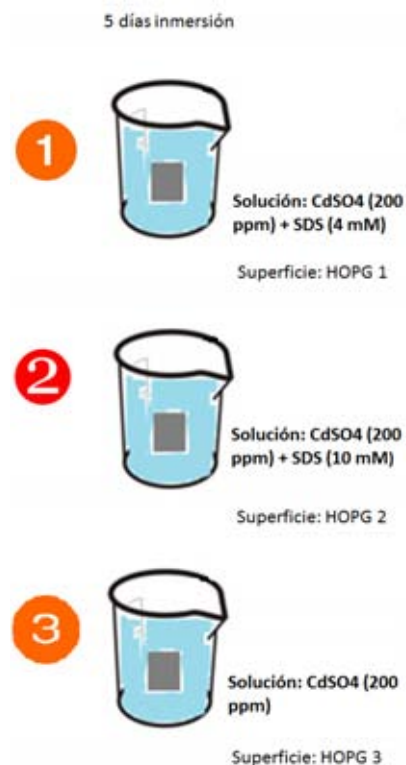
FIGURA 3.6. Esquema de la preparación de las muestras. Para los tres casos la única etapa consiste en la adsorción del contaminante mediante el surfactante SDS a la superficie. Todas las soluciones tienen una mezcla de CdSO 4 a una concentración 0.96 mM. La etiqueta número 1 indica que la mezcla tiene una concentración de SDS 10 mM, la etiqueta número 2 indica que la mezcla tiene una concentración de SDS 4 mM y la etiqueta número 3 indica la referencia con Agua Mili-Q.
