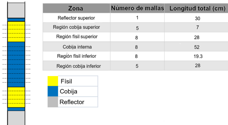
Figura 1.4: Configuración axial del RBWR usada por PARCS
