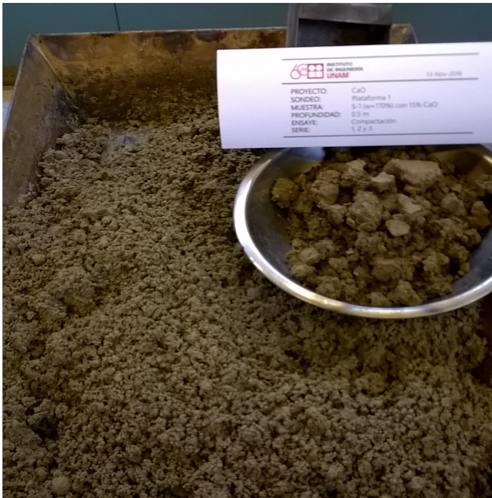
Figura B 1 Mezcla de S-1 con 15% de CaO. Se muestra la diferencia del material mezclado y el material natural.
