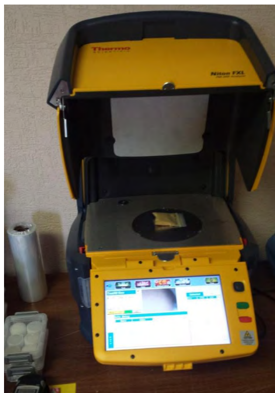
Figura 3.34 Equipo de FRX portátil marca Thermo Scientific modelo Niton FXL 950 FM-XRF Analyzer. La muestra es montada en el analizador para ser irradiada por rayos X.
