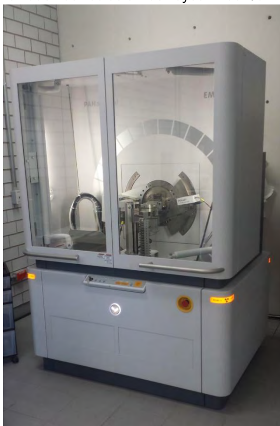
Figura 3.18 Difractómetro PANalytical Empyrean con un monocromador de \text{CuK}\alpha ( \lambda=1.54056 \text{ \AA} ) utilizado para este estudio.
