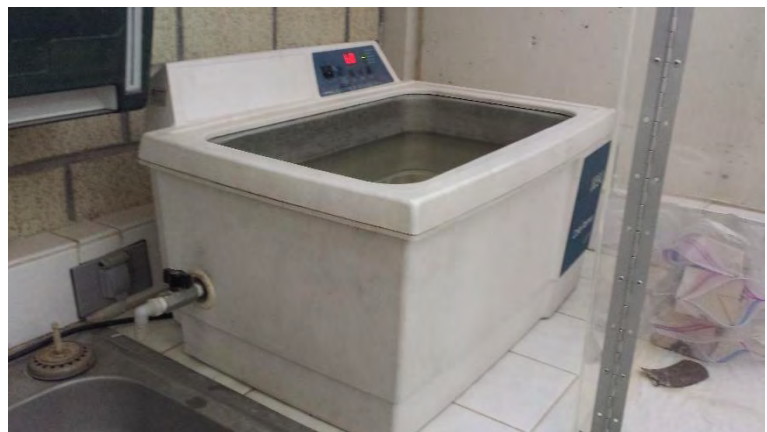
Figura 3.13 Tina ultrasónica marca Cole-Parmer modelo 8894, es utilizada para retirar las partículas retenidas en las mallas para tamizar.
