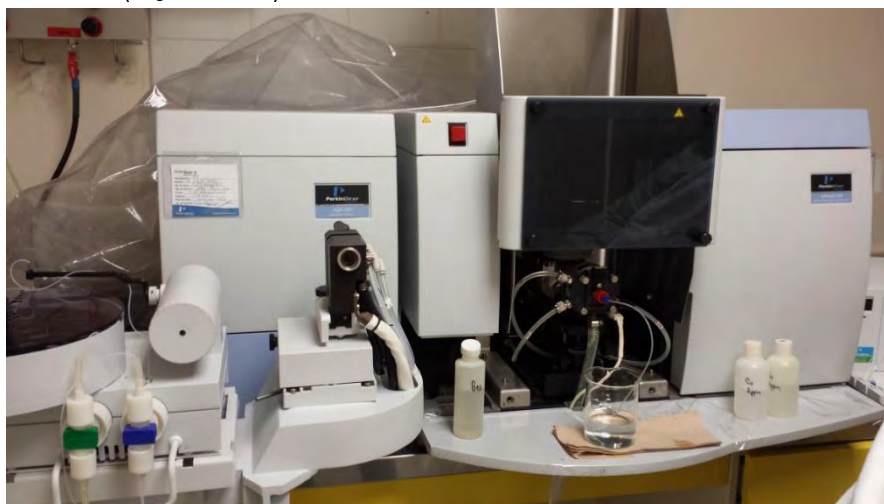
Figura 3.60 Espectrofotómetro de Absorción Atómica Analyst 400 de la marca Perkin Elmer utilizado para este estudio.
