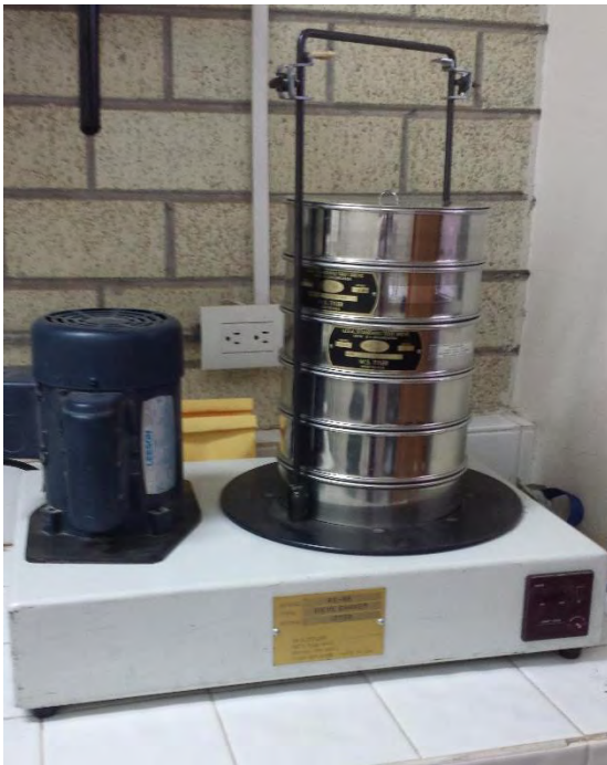
Figura 3.12 Rotap marca H&P Equipment modelo RX-86 utilizado para la agitación y separación por fracciones del material.
