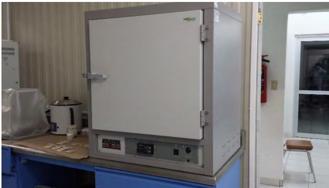
Figura 3.10 Horno marca Hafo Series 1600, las muestras se secaron a temperatura ambiente de 35° C.
