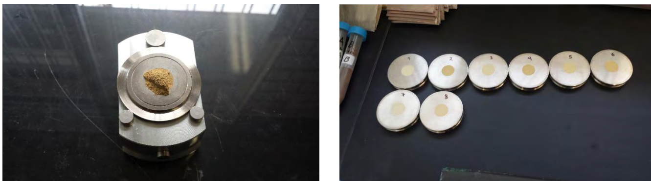
Figura 3.19 Porta muestras especial para el equipo de difracción. El polvo obtenido de la molturación es vertido en los porta muestras y se va aplanando hasta obtener su forma circular.
