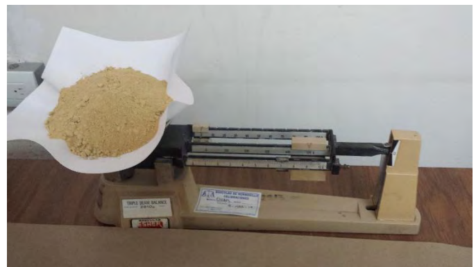
Figura 3.11 Báscula de precisión utilizada para la medición del peso de las muestras a tamizar. Se calcula el peso inicial y el peso por cada fracción obtenida.
