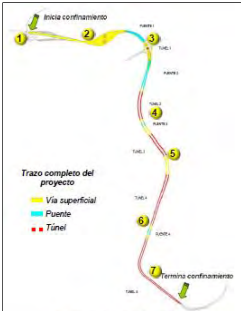
Figura 3A. Trazo esquemático del proyecto Supervía Poniente.
