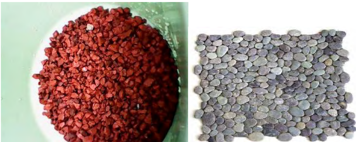
Figura A.2.2. Materiales de empaque utilizados. En el lado izquierdo tezontle y lado derecho piedra de río. Ambos con el mismo tamaño de partícula graduada.
