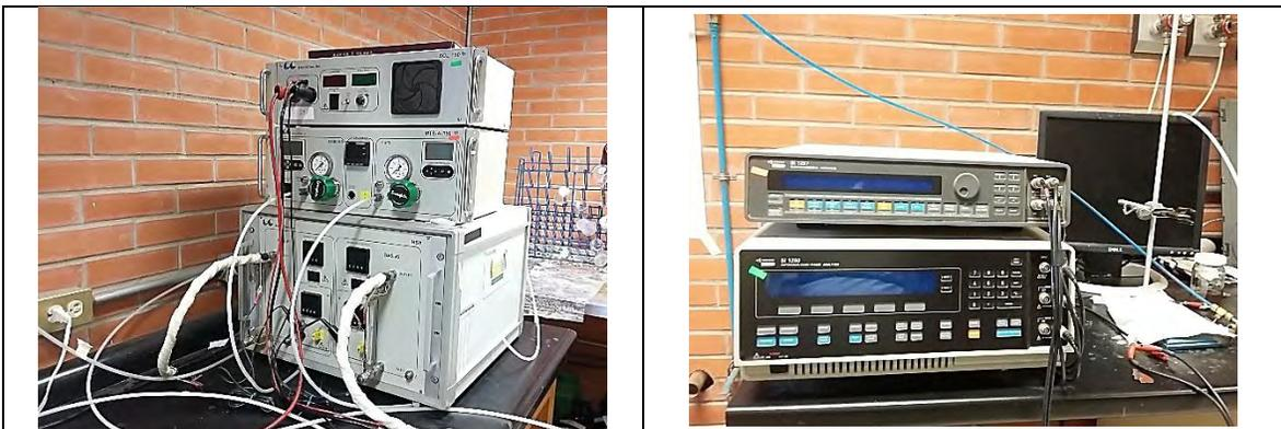
Fig. 1.2.2 Integración de equipos comerciales para la estimación de la curva de potencia en celdas de combustible.
