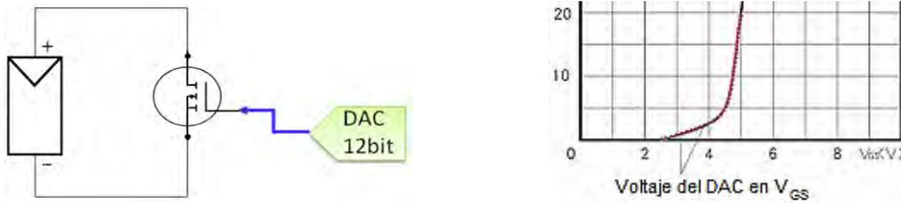
Fig. 3.5.8 Voltaje de compuerta  $V_{GS}$  controlado por voltaje del DAC.
