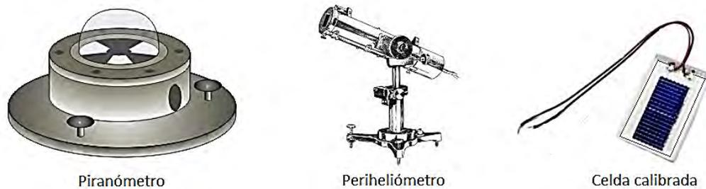
Fig. 2.3.5.2 Instrumentos para medir la irradiancia.
