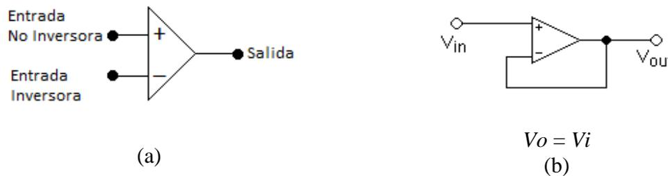
Fig. 2.3.1.2 Amplificador operacional (a) Símbolo y partes constitutivas; (b) Configuración del amplificador operacional como seguidor de voltaje.
