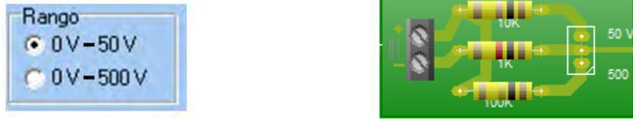
Fig. 3.3.2 Selección manual de rango de medición.
