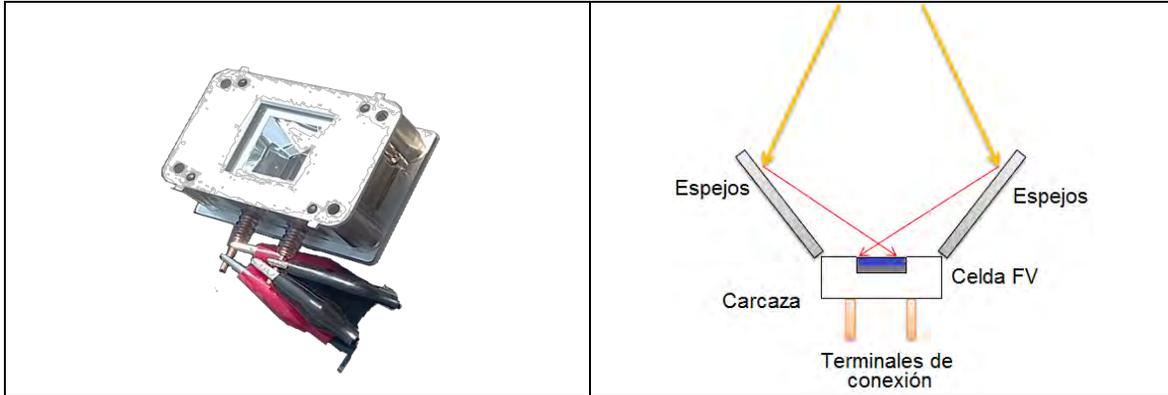
Fig. 5.7.1.1 Celda solar con concentrador de 4 espejos.
