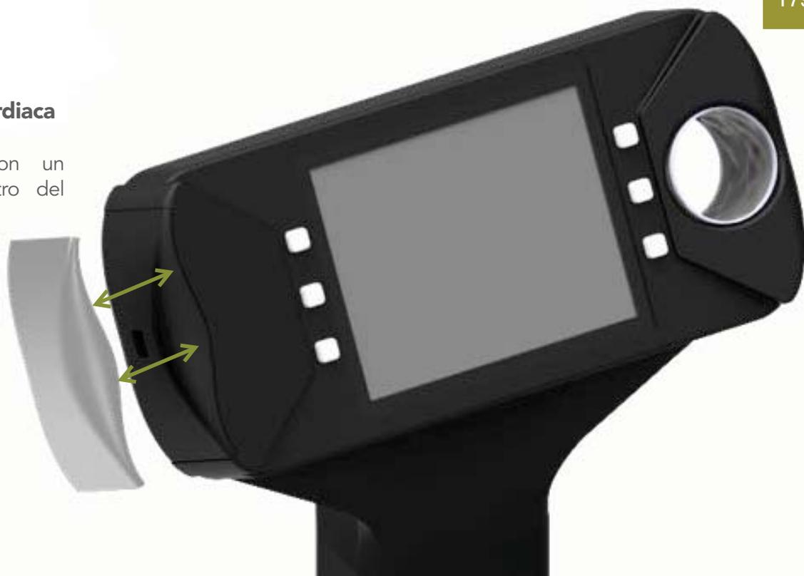
Fig. 153 | Unión del sensor de frecuencia cardiaca al tablero
