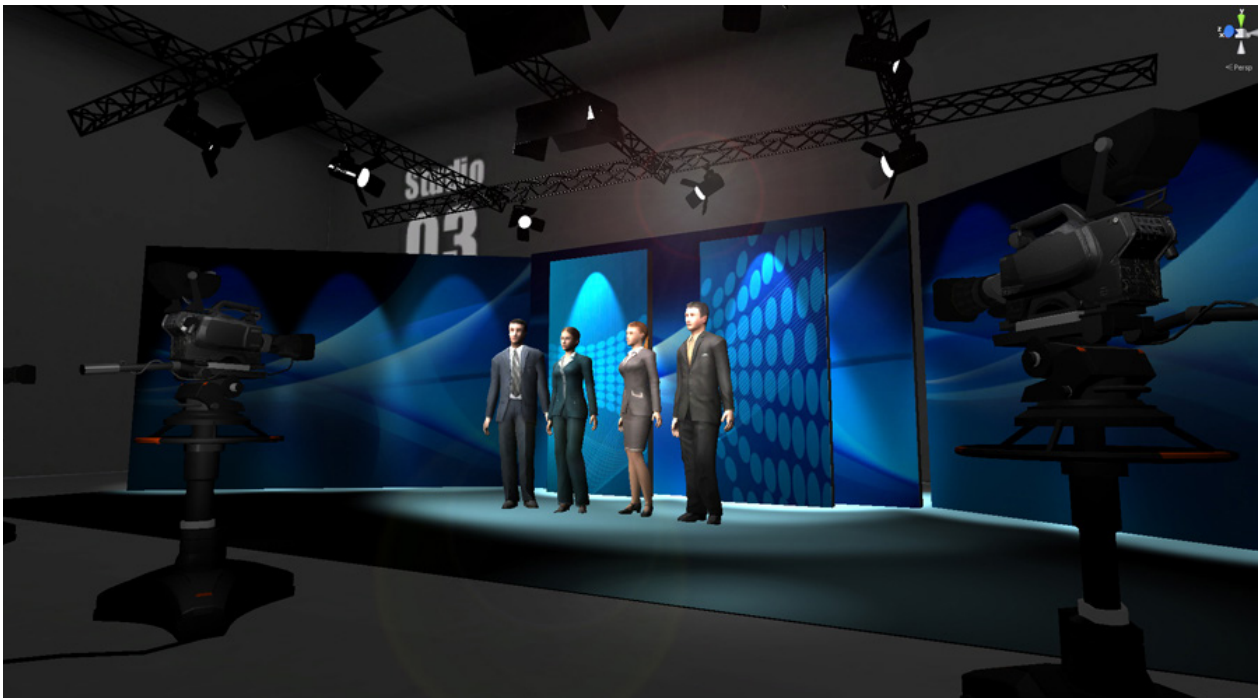
Figura 50. Configuración inicial de estudio virtual de televisión en software de composición tridimensional. Es posible observar los modelos utilizados en el Set , como los talentos, al centro; las cámaras en primer plano, las luces en la parte superior del set colgadas dentro de una estructura truss y al fondo modelos 3D simulando un escenario. (Fuente Propia)
