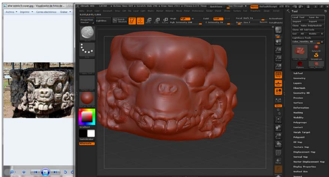
Figura 31. Modelado de la base de Tigre con referencia fotográfica en software de modelado topológico ZBrush. En este tipo de software, el modelo puede contener más detalle que posteriormente se guarda en texturas y mapas normales. (Fuente propia)
