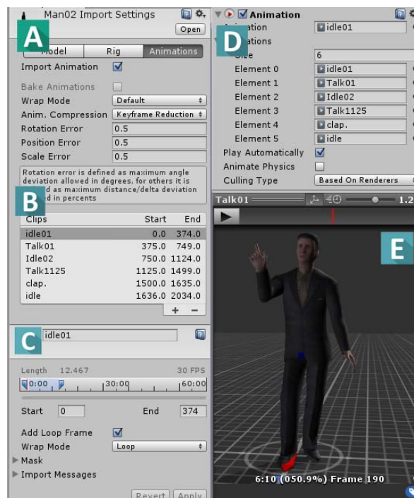
Figura 53. Módulo Animation de Unity3D con la secuencia de animaciones importadas en el modelo FBX. Se puede observar en el panel izquierdo el panel de Animaciones (A) con la opción wrap mode que permite animar con repetición las rutinas cargadas. El panel de Clips (B) que muestra todas las secuencias de animación reconocidas en el modelo del personaje FBX exportado desde el software de producción tridimensional. El panel de Clip Individual (C) permite modificar la duración de cada clip o secuencia de animación. El panel Animations Size (D) agrega las secuencias de animación cargadas en un orden individual según una nueva secuencia generada en el software de composición tridimensional y el Panel Preview (E) que brinda una vista previa de la secuencia de animación asignada al modelo tridimensional con los frames animados. (Fuente propia)
