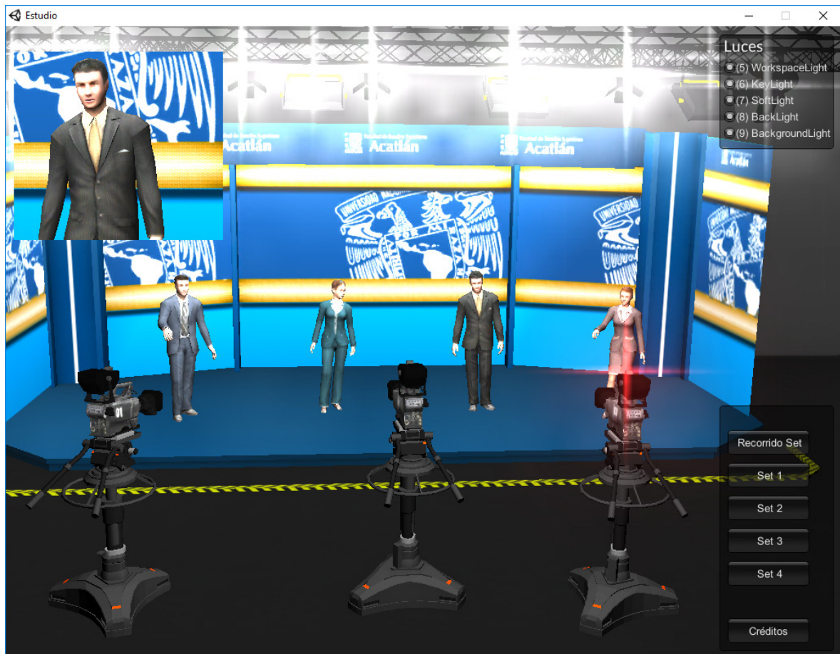
Figura 56. Diseño final de la interface del entorno Estudio de Televisión. El área de interacción principal se centra en la pantalla teniendo como zonas activas el recuadro en la parte superior izquierda que muestra la cámara activa. El usuario puede identificar qué cámara está manipulando por la luz de Tally en color rojo activa sobre el modelo tridimensional de la cámara. Del lado derecho aparecen tres bloques de botones en el caso del set 01 y dos bloques en los sets 02 al 04. En el bloque superior derecho es posible controlar la iluminación de cada set mediante los dispositivos de interacción mouse , al dar clic en la zona seleccionada o mediante el teclado apretando la tecla mostrada entre paréntesis. El bloque inferior derecho permite el cambio de escena hacia cualquiera de los cuatro sets mediante el dispositivo de interacción mouse al apretar alguno de los botones. Por último se agregó un botón adicional para mostrar los créditos del proyecto (Fuente Propia).
