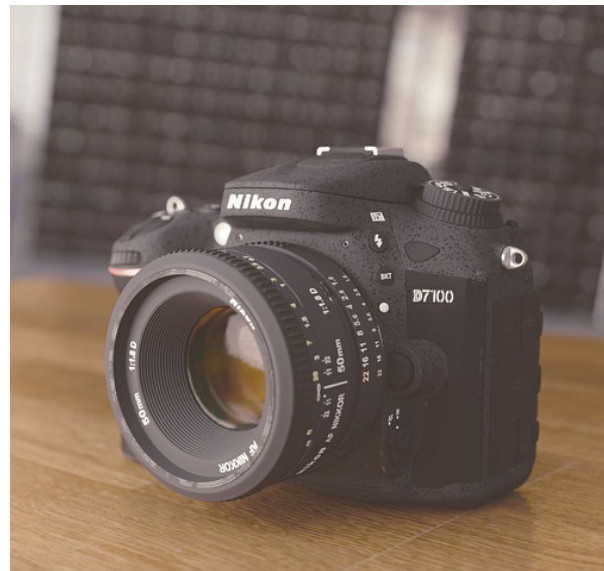
Figura 25. Modelo tridimensional de cámara en donde se agregan detalles mediante el uso de texturas. Sin necesidad de modelar polígonos adicionales. Los números en el objetivo, la marca de la cámara y el modelo son aplicados mediante texturas. (Pixabay, 2015)
