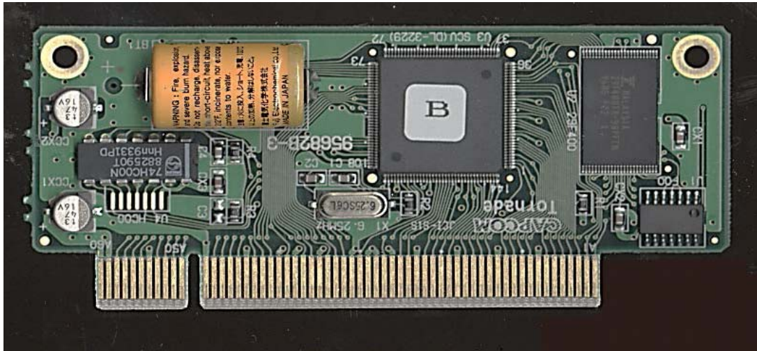
Placa tipo B del cartucho de Stret Fighter3: 2nd impact, la cual presentaba un problema de diseño a largo plazo, debido a que al terminarse la pila (en color amarillo) se le debía cambiar para que continuara funcionando, pero durante este proceso si la placa quedaba sin carga podía “suicidarse” y dejar de funcionar en sus totalidad. FUENTE: HTTP://WIKI.ARCADES.MX/IMAGES/3/3B/CPSIII-FRONT.PNG
