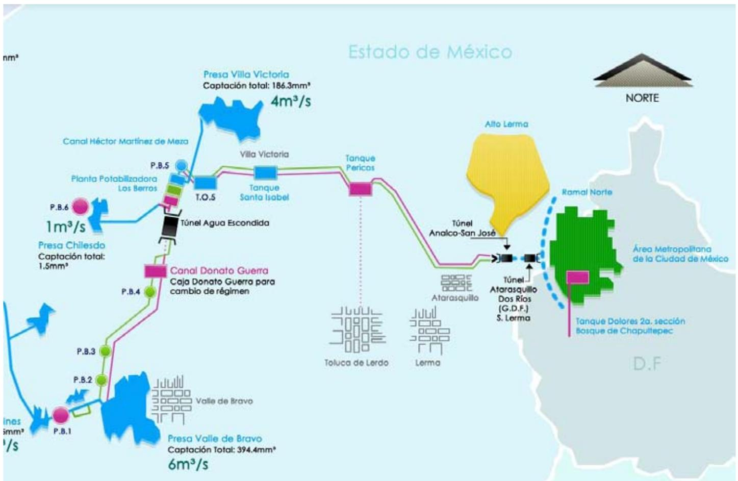
Figura 4. Esquema del Sistema Cutzamala (SC). Se muestran las rutas de transporte de agua a la Ciudad de México. Tomado de <http://www.agua.org.mx/cono/multimedia/mapas/1131-mapas/11433-croquis-del-sistema-cutzamala>
