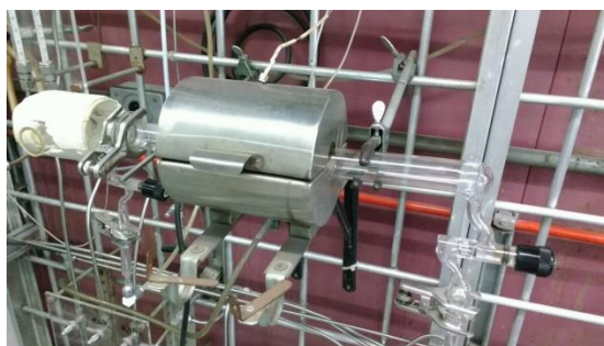
Figura 2.12 Celda en línea de sulfuración
