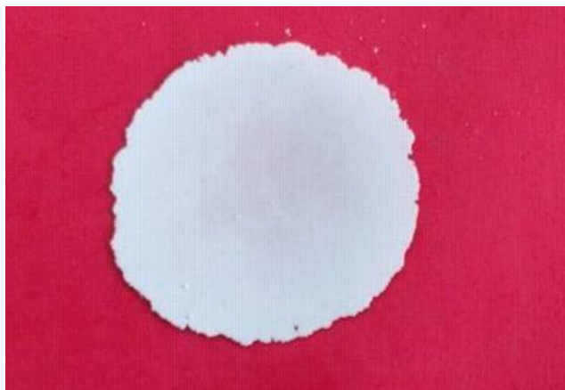
Figura 2.1 Pastilla del catalizador Mo/Al 2 O 3
