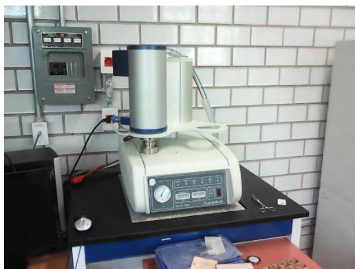
Fig. 3.17. Equipo termogravimétrico STA PT1600
