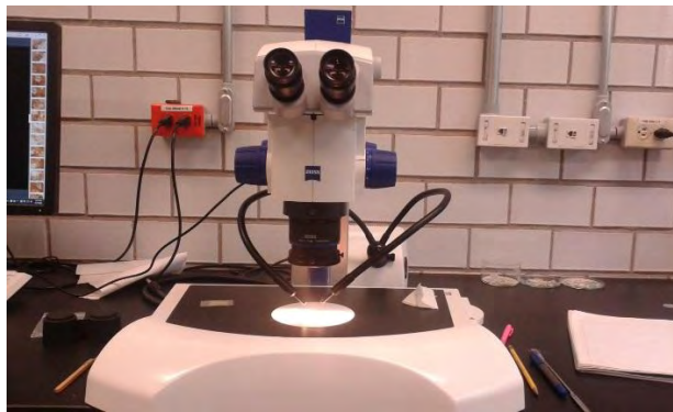
Fig. 3.11. Microscopio estereoscópico utilizado para observar las láminas delgadas.
