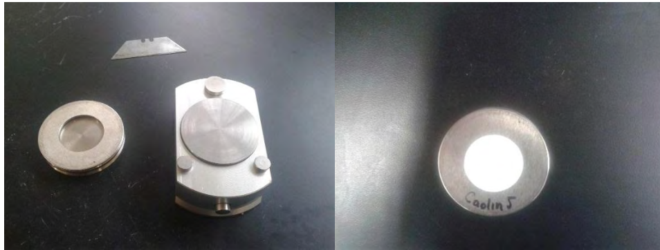
Fig. 3.8. Elementos utilizados para montar una muestra y muestra montada en el portamuestras, lista para ser analizada.
