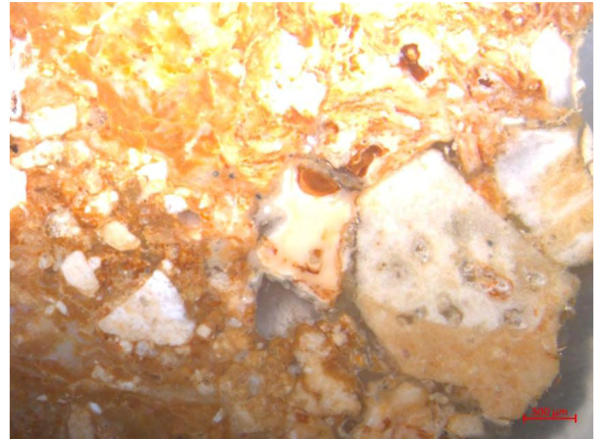
Fig. 4.22. Imagen de microscopio estereoscópico de la muestra M4, en donde se puede observar la coloración rojiza del mineral.
