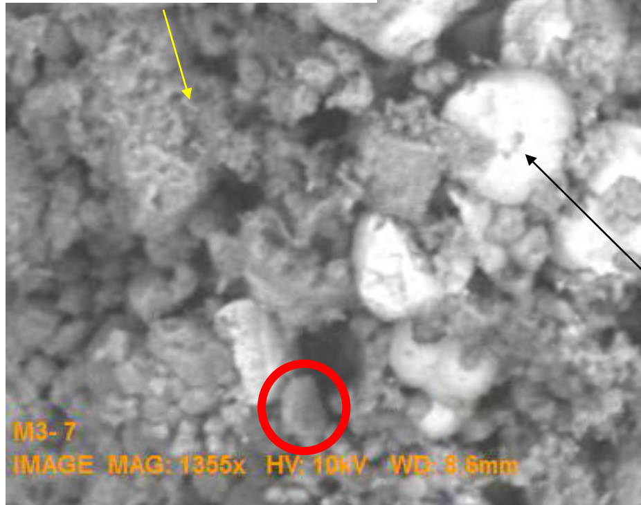
Fig. 4.26. Imagen de MEB con zoom de 1365X, de la muestra M2, dónde el círculo rojo nos indica la morfología del caolín
