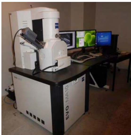
Fig. 3.10. Microscopio Electrónico de Barrido modelo EVO MA 10 ZEISS
