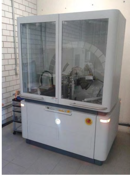
Fig. 3.7. Difractómetro de Rayos X EMPYREAN, Instituto de Geología, UNAM
