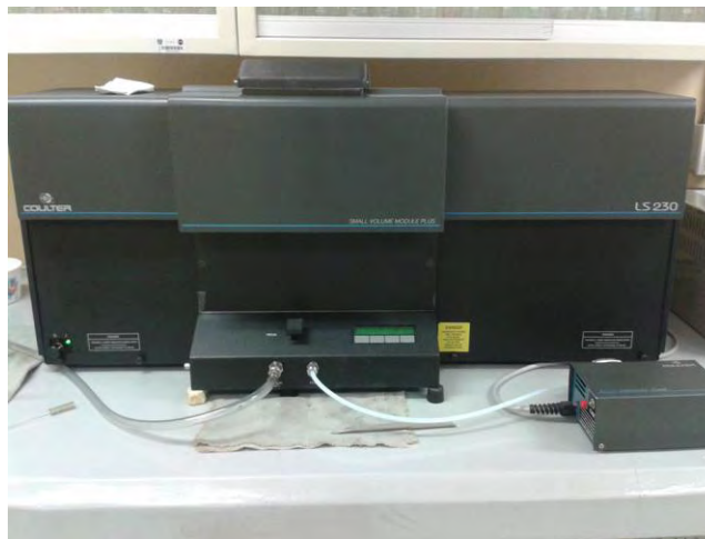
Fig. 3.20. Equipo de difracción láser BECKMAN COULTER modelo LS 230
