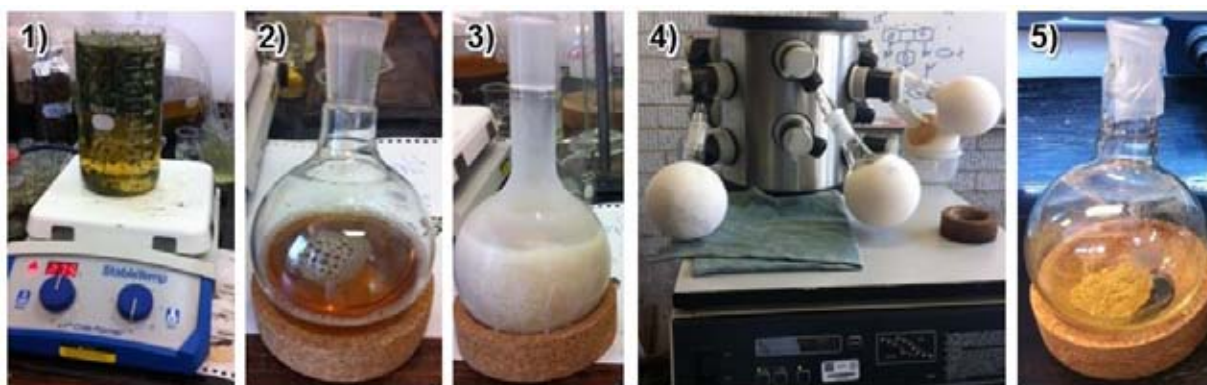
Figura 10. Proceso de obtención del extracto acuoso: 1) Infusión de Phyllonoma laticuspis (Turcz); 2) Filtrado; 3) Congelado de la; 4) Eliminación del agua en liofilizadora; 5) Extracto acuoso seco.
