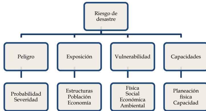
Figura 1.1. Esquema que muestra los factores considerados en el Modelo de Bollin et al. (2003) para explicar el riesgo de desastre.
