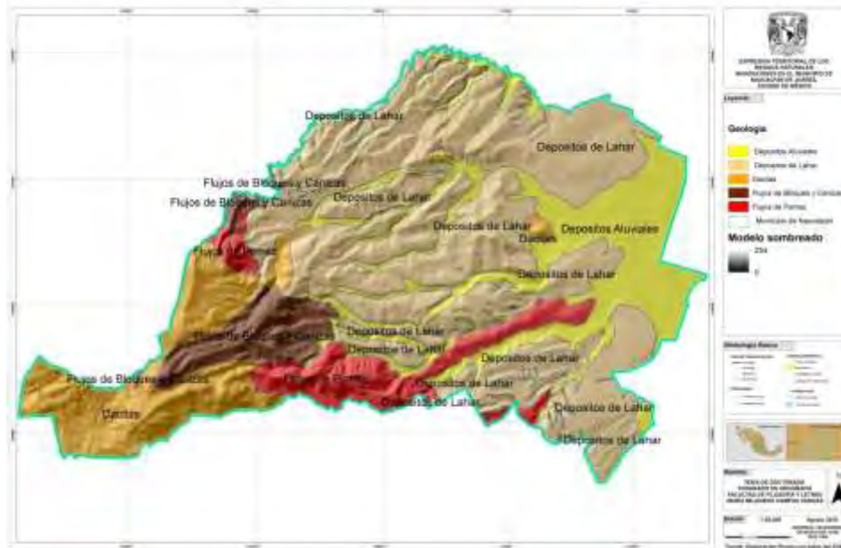
Figura 4.2. Mapa que muestra los depósitos aluviales y de Lahar; flujos de Bloques y Cenizas, así como de Pomez; y dacitas que se encuentran en la geología de Naucalpan. Elaboración propia con datos de INEGI, 2010.
