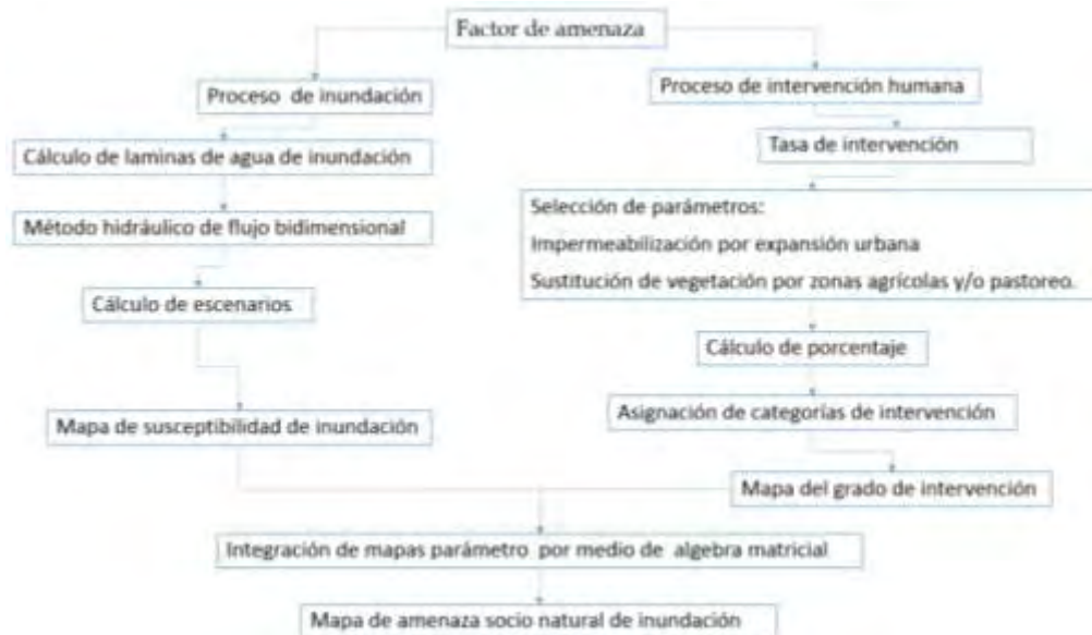
Figura 3.4. El diagrama muestra la metodología que se sigue para calcular el factor de amenaza de inundación, a partir de considerar los elementos de los procesos de inundación e intervención humana. Elaboración propia, 2016.
