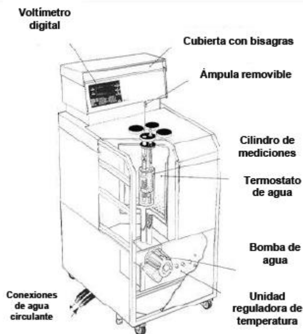
Figura 3.6. Representación de equipo TAM, Thermometric, Suecia y sus diferentes compartimentos.
