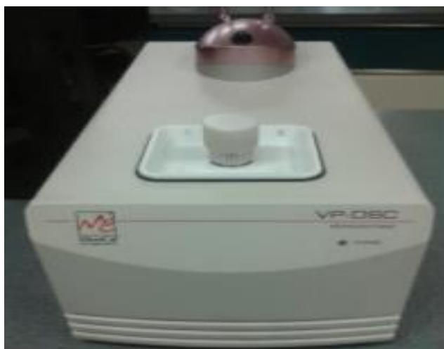
Figura 4.2. Equipo Microcal VP-DSC empleado para determinación de los parámetros termodinámicos de los sistemas liposomales antes y después de la titulación calorimétrica con el tensoactivo no iónico OGP[12].
