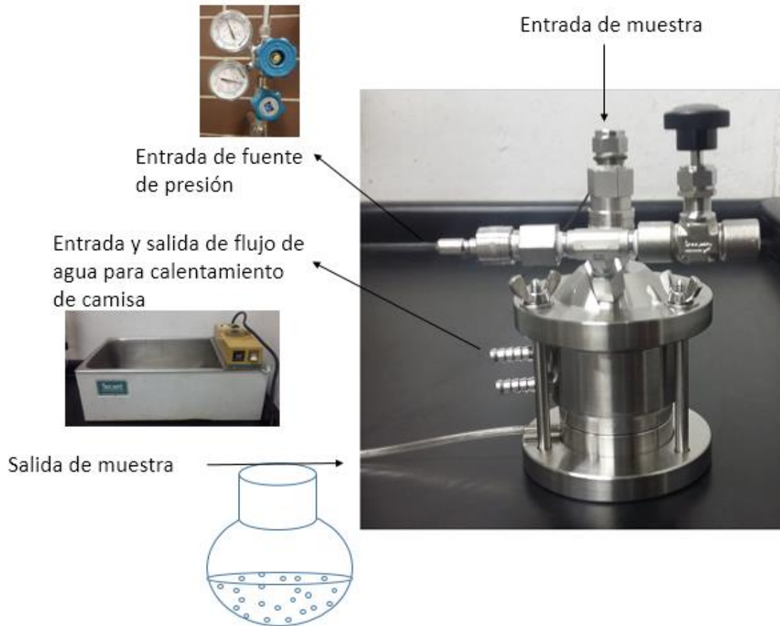
Figura 2.4. Imagen del equipo Extruder empleado en este trabajo. Las membranas utilizadas fueron de 100 nm y la presión aplicada alrededor de 30 atm.
