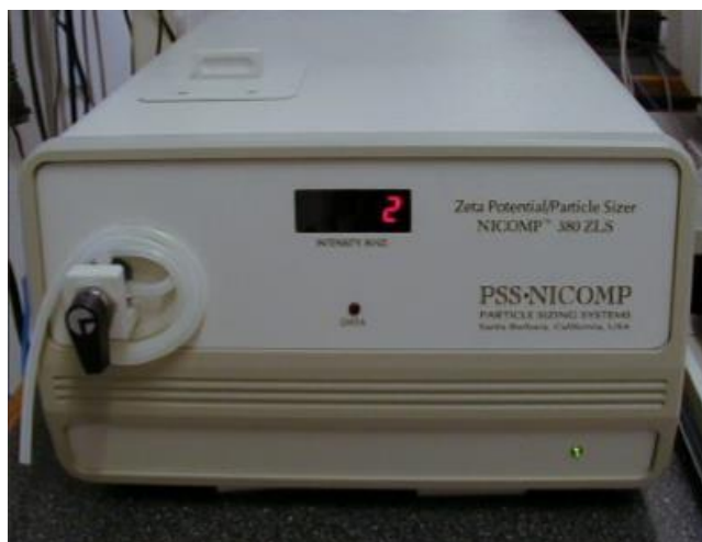
Figura 4.1. Imagen del equipo NICOMP 380 ZLS Particle Sizer, con el que se realizó el análisis de tamaño de partícula y potencial Z por dispersión dinámica de luz y dispersión de luz electroforética respectivamente.
