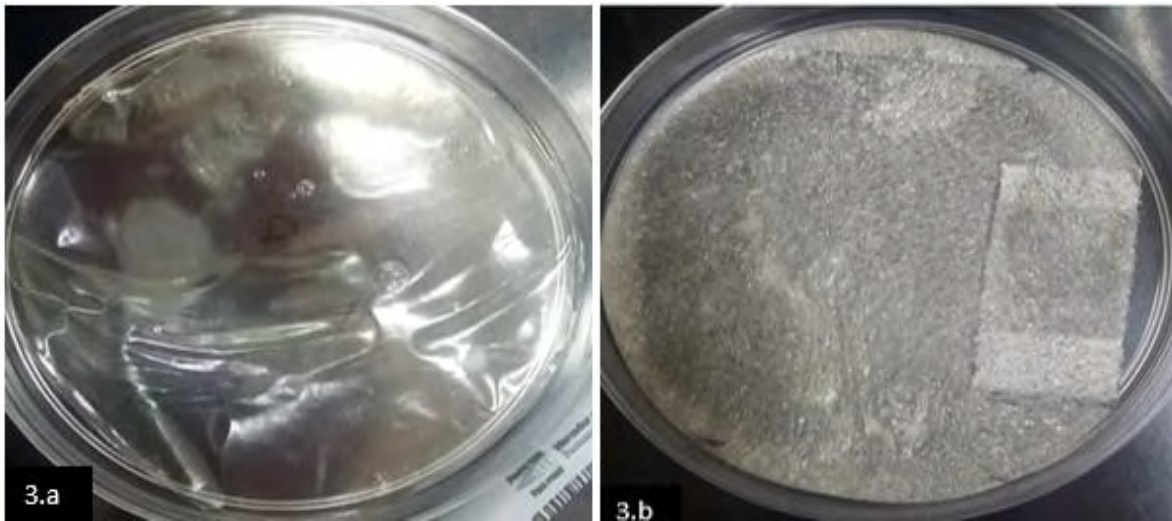
Figura 32. Membrana con 0.15% de \text{CaCl}_2 1.a) secada al ambiente, 1.b) liofilizada.
