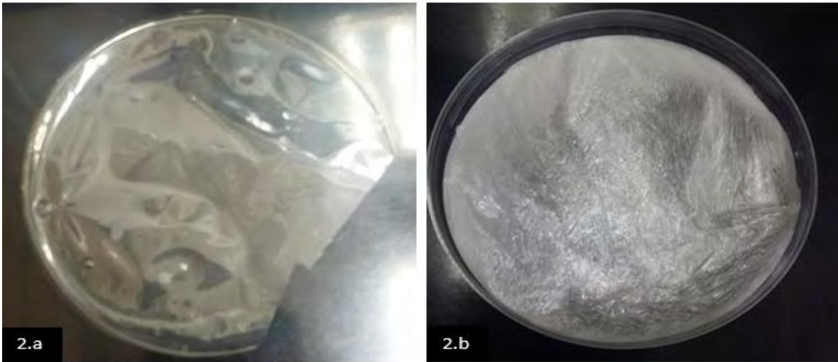
Figura 31. Membrana con 0.1% de \text{CaCl}_2 1.a) secada al ambiente, 1.b) liofilizada.
