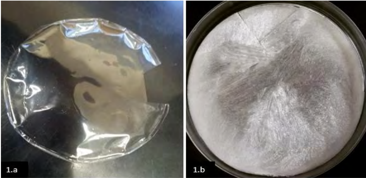
Figura 30. Membrana con 0.075% de \text{CaCl}_2 1.a) secada al ambiente, 1.b) liofilizada.
