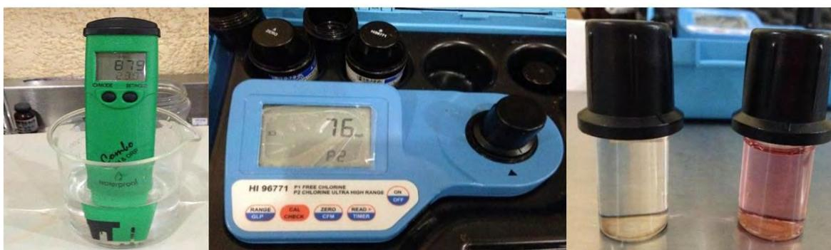
Figura A1. Equipo utilizado para el análisis químico. Electrodo portátil impermeable (izquierda), fotómetro portátil (centro) y Reactivos blanco A y B
