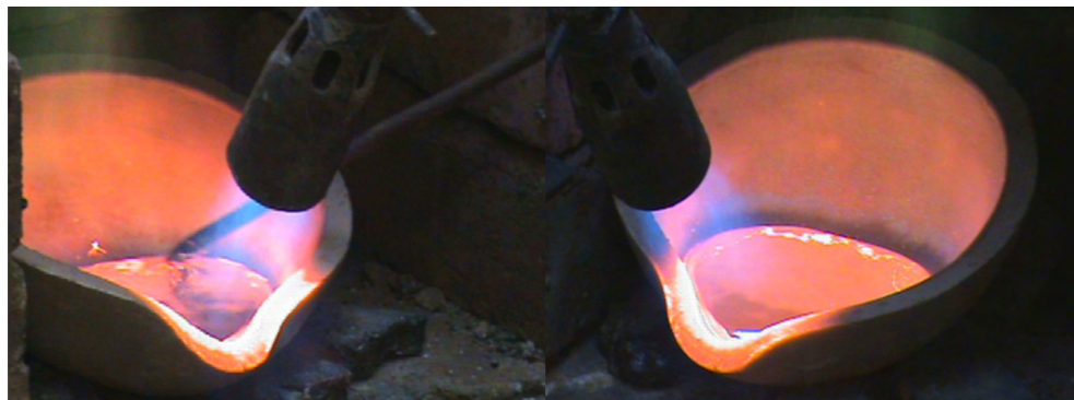
Fig.61 Cobre y plata en proceso de amalgamación alcanzando su punto de fusión
