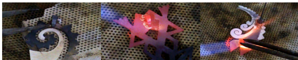
Fig. 71 Soldado de pasa-cadenas y sistema de broche
