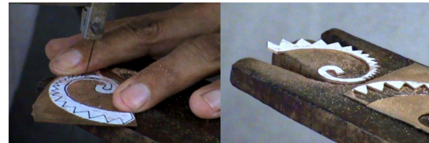
Fig. 64 Para calar se utilizaron seguetas #0000
