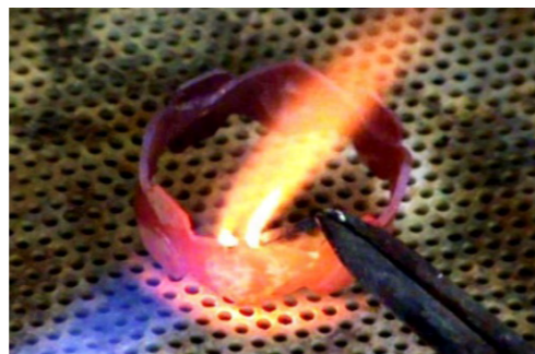
Fig.55 Imagen donde se muestra el momento preciso de unión entre soldadura y componentes a soldar
