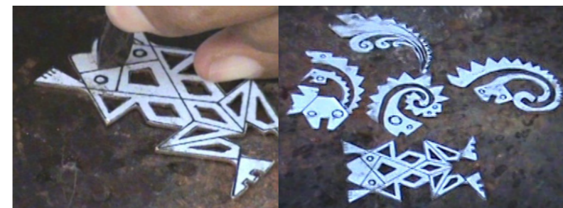
Fig.66 Trazado de líneas con cincel
