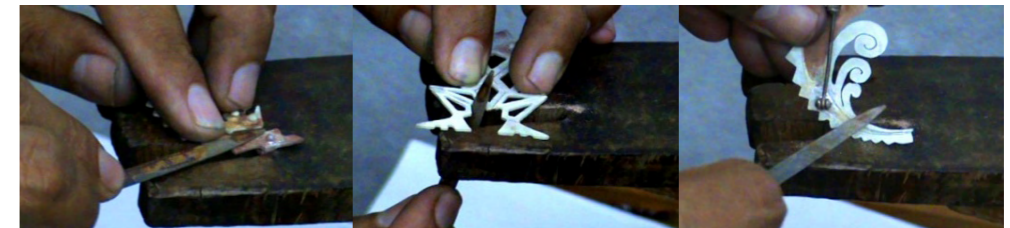
Fig.72 Limado de residuos de soldadura.
