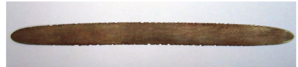
Fig.42 Placa laminada y limpiada con ácido sulfúrico
