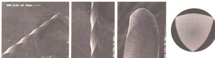
Figura 23: Características de los instrumentos Protaper Universal Retreatment al MEB. (Fuente: Gustavo Horacio Lopreite JMB. Claves de la endodoncia mecanizada Buenos Aires: Grupo Guía; 2016.)
