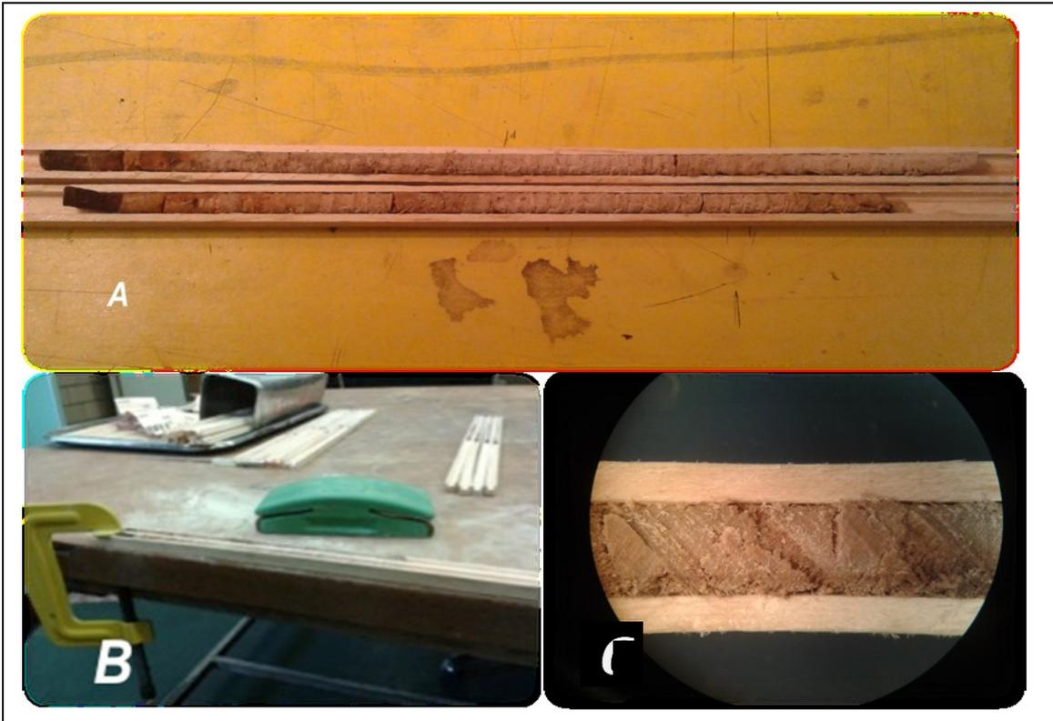
Figura 10.-A) Núcleos colocados en los bastidores de madera. B) Lijado de los núcleos (600, 400, 200 grosor de lijas). C) Núcleos orientados y colocados en bastidores.
