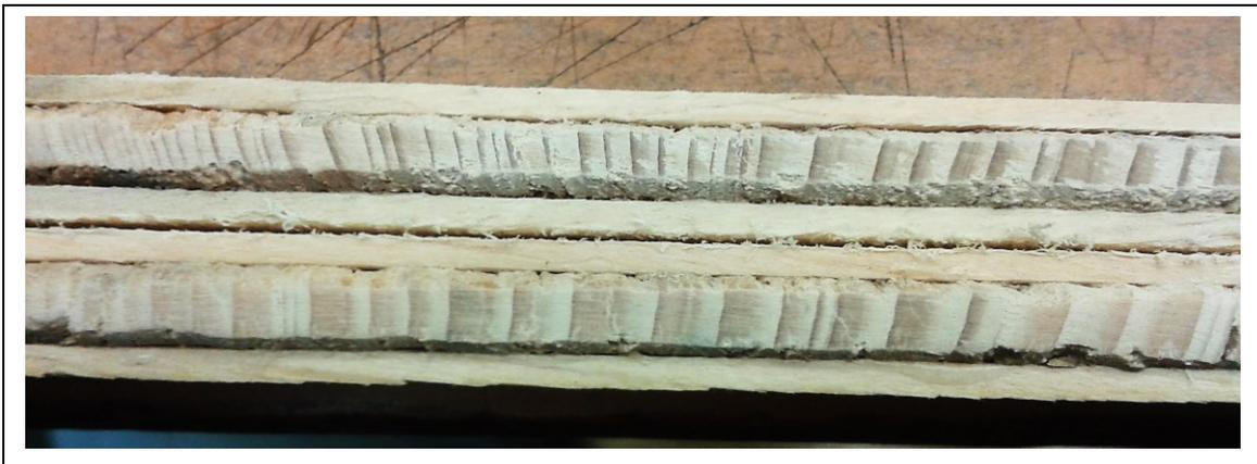
Figura 11.- Núcleos lijados antes de colocar papel milimétrico.
