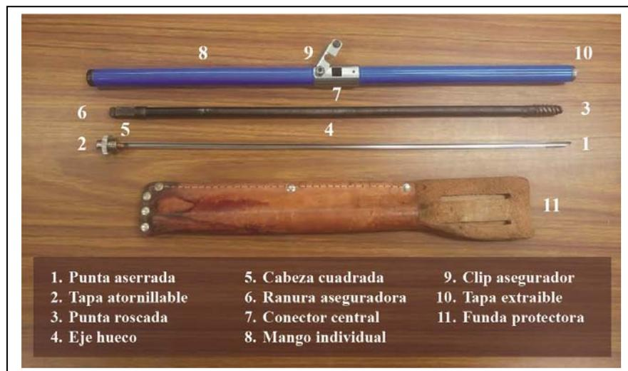
Figura 8.-Partes que conforman al barreno de Pressler (modificado-de-Jozsa-1988).
