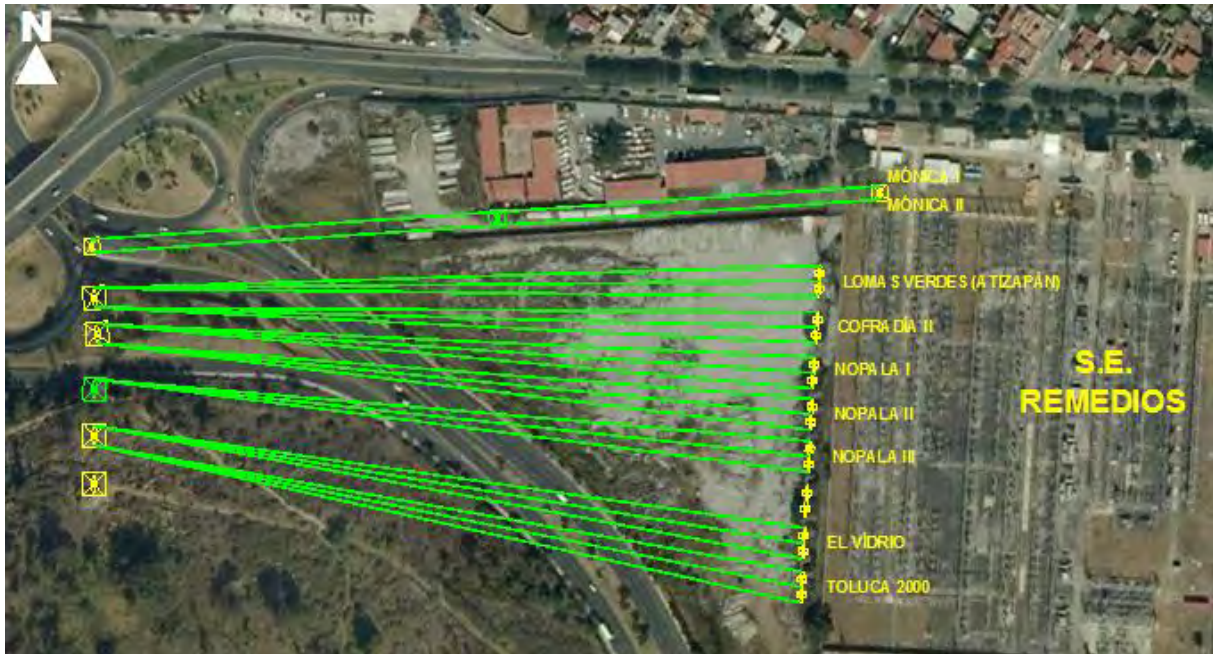
Ilustración 9. Reubicación de líneas de transmisión SE Los Remedios CFE.
