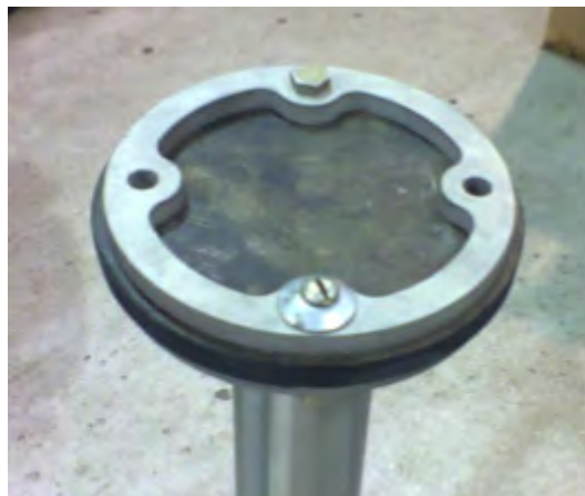
Figura 5.55: Bidas del vástago con sello. (Cortesía de [23])
