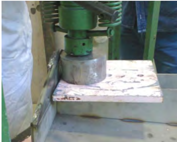
Figura 5.16: Enderezando placas con prensa.
