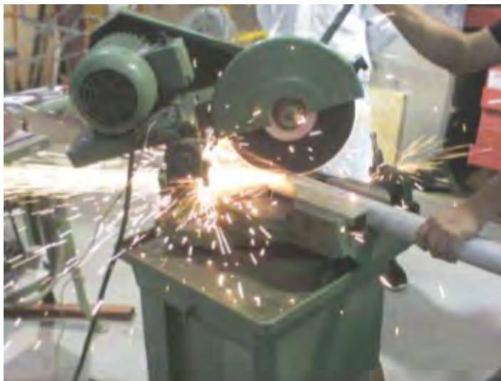
Figura 5.22: Corte de tubos a 45 grados. (Cortesía de [23])
