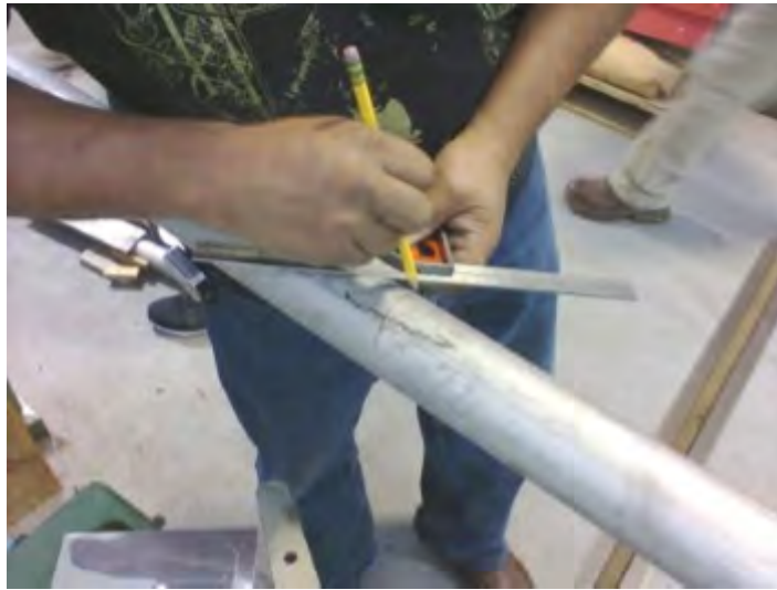
Figura 5.21: Se cortan los tubos a 45 grados. (Cortesía de [23])
