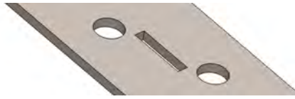
Figura 4.26: Barrenos para cable de cierre inferior. (Elaboración propia.)
