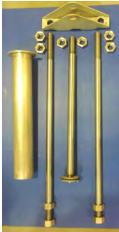
Figura 5.63: Amortiguador terminado. (Cortesía de [23])
