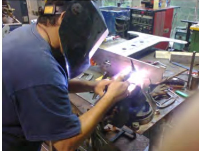
Figura 5.11: Placa sujeta soldada.
