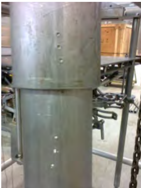
Figura 5.104: Marcación de las patas y toldos para su identificación. (Cortesía de [23])
