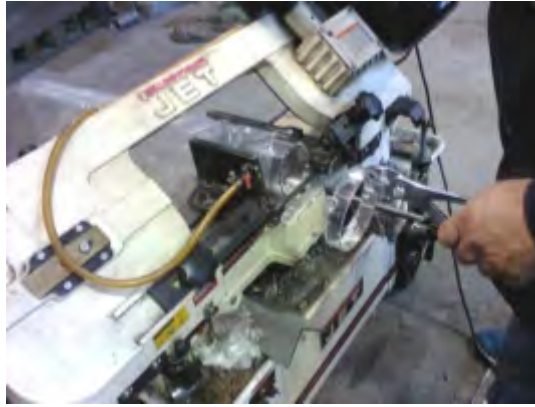
Figura 5.72: Corte de los tubos de policarbonato.
