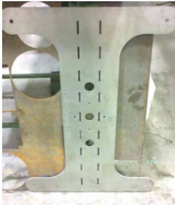
Figura 5.3: Placa de la estructura secundaria terminada. (Cortesía de [23])
