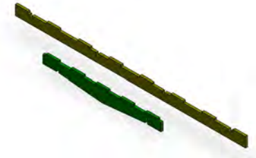
Figura 4.24: Largero y travesaño de la placa de tubos.
