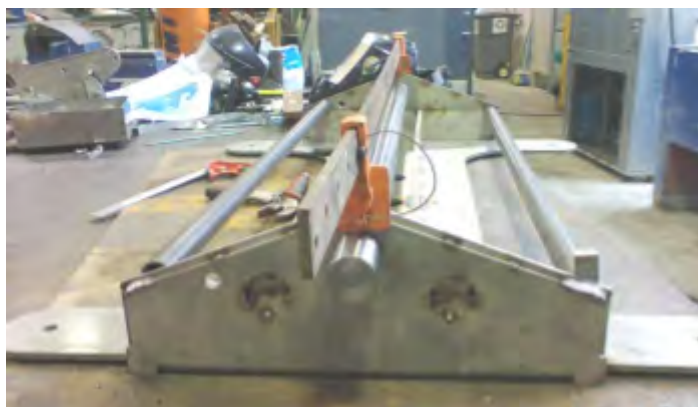
Figura 5.12: Placa con guías para alinearse.
