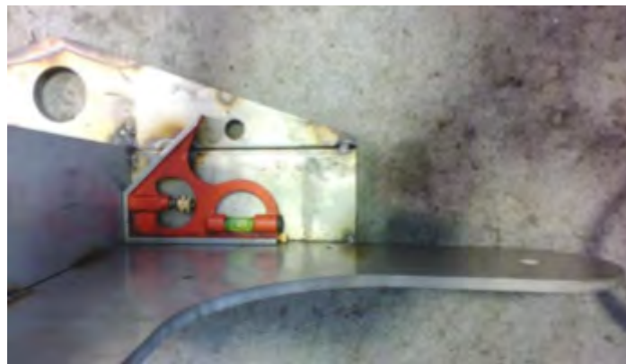
Figura 5.14: Escuadra para nivelarlo. (Cortesía de [23])
