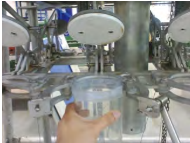
Figura 5.79: Colocación de los tubos de policarbonato en las mordazas.
