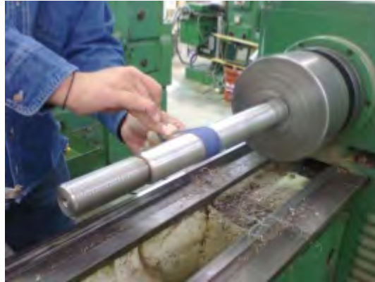
Figura 5.54: Acabado de émbolo del amortiguador en el torno. (Cortesía de [23])
