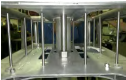
Figura 5.49: Guías colocadas en la placa de pesas.
