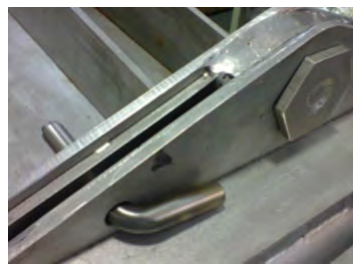
Figura 6.35: Perno de seguridad entre orejas de los marcos. (Cortesía de [22])
