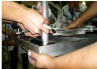
Figura 6.29: Inserción de la placa de guillotinas. (Cortesía de [22])
