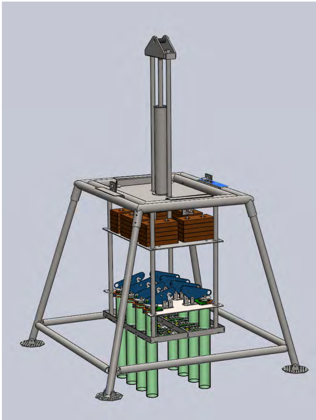
Figura 4.43: Diseño del multinucleador completo.
