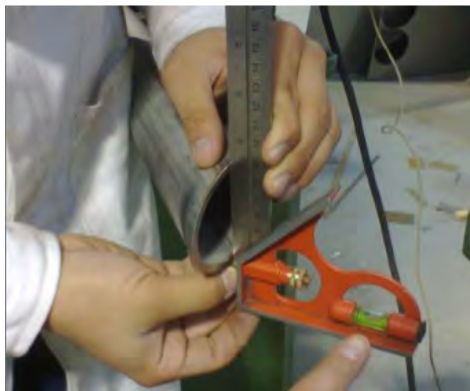
Figura 5.24: Verificando el ángulo con nivel. (Cortesía de [23])
