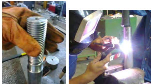
(a) Vástago dentro del émbolo. (b) Soldadura del vástago con el tubo (émbolo).
