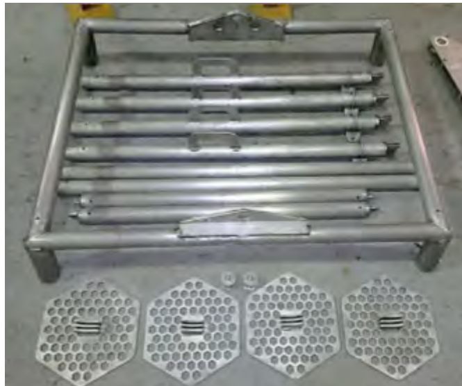
Figura 5.106: Piezas de la estructura externa. (Cortesía de [23])
