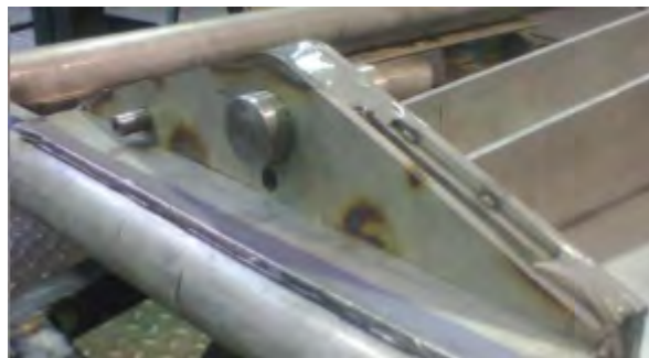
Figura 5.31: Soporte recortado sin material sobrante.
