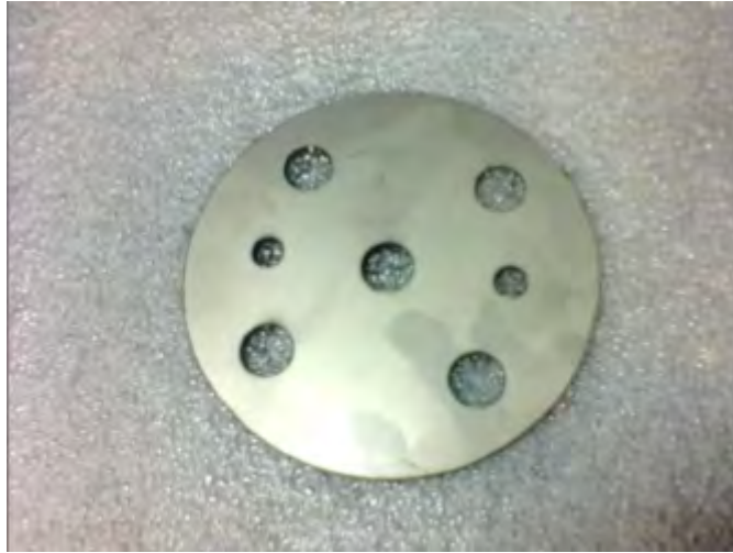
Figura 5.74: Alma de la tapa de cierre superior. (Cortesía de [23])
