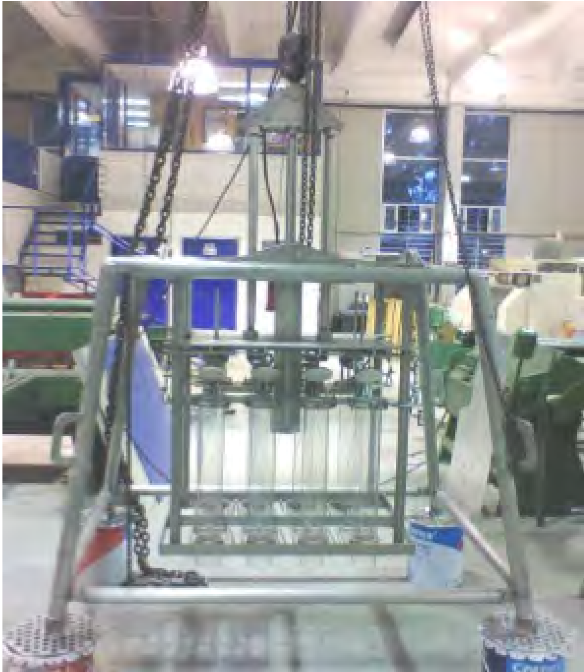
Figura 6.36: Ensamble del multinucleador de ocho tubos terminado. (Cortesía de [22])
