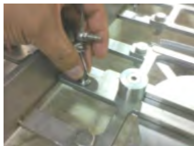
Figura 6.32: Colocación del seguro de la guillotina.
