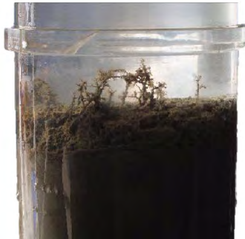
Figura 2.11: Núcleo de sedimento marino con una interfaz agua-sedimento. (Tomado de [19])
