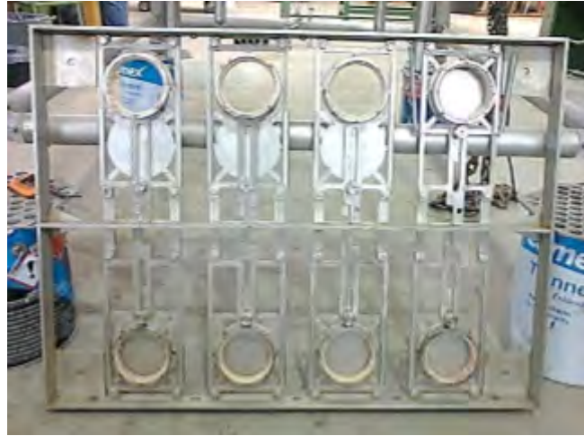
Figura 5.90: Placa de guillotinas Trterminada (sistema de cierre inferior). (Cortesía de [23])
