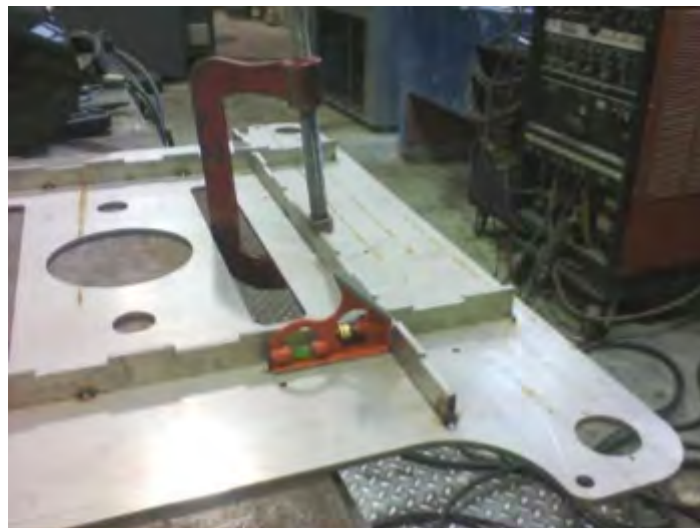
Figura 5.38: Largueros colocados, escuadrados y sujetas a la placa con prensas. (Cortesía de [23])
