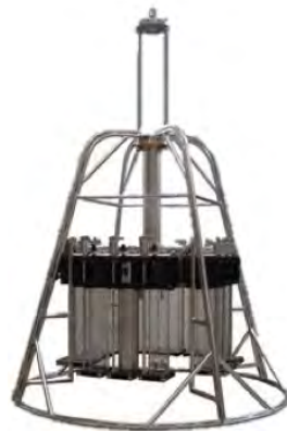
Figura 2.1: Multinucleador OSIL (Tomado de [18])
