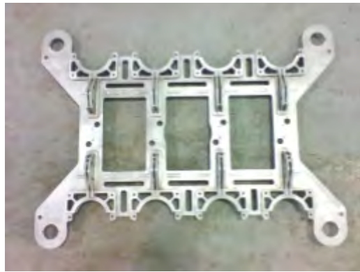
Figura 5.66: Vista superior de la placa de tubos con soportes para los mecanismos de cierre superior.
