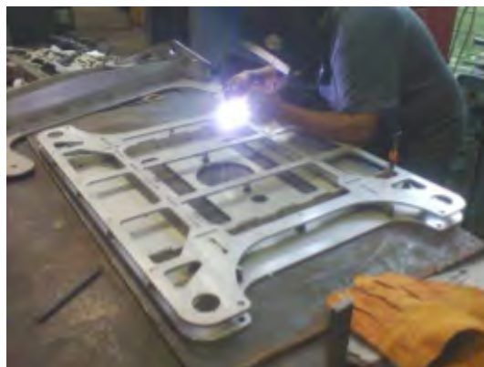
Figura 5.42: Soldadura de los largueros con la placa inferior de la placa de pesas. (Cortesía de [23])
