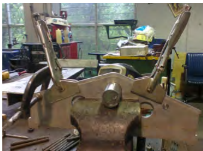
Figura 5.10: Sujeción de soporte de placa para soldarse.
