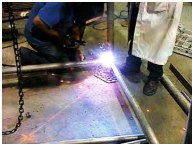
Figura 5.101: Soldadura de los anillos de unión de las patas de la estructura externa.
