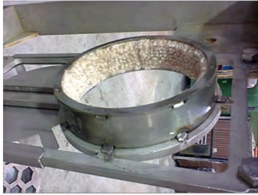
Figura 7.5: Guarda felpa punteada al marco de la guillotina.
