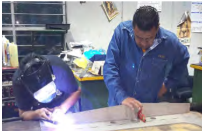
Figura 5.4: Soldando el ala. (Cortesía de [23])
