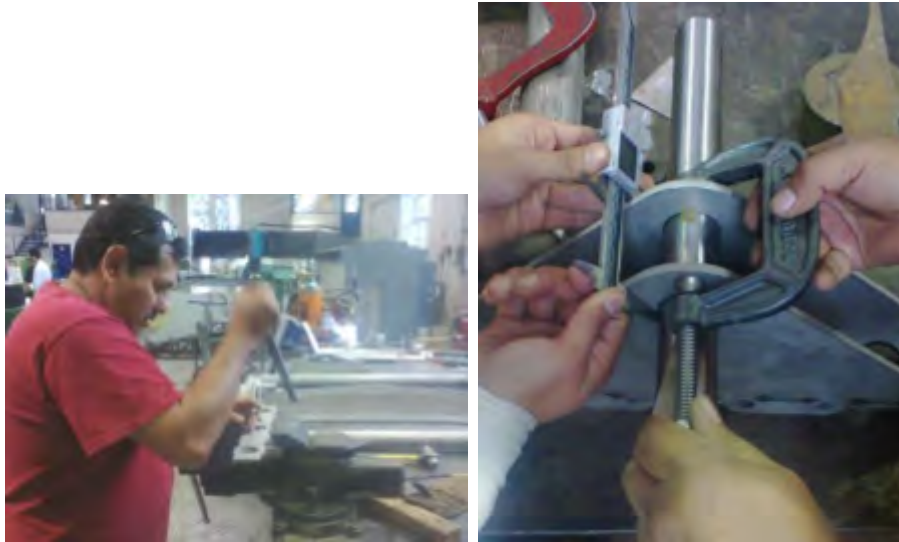
(a) Preparación de las piezas del yugo. (b) Se alinean las orejas a la distancia adecuada.
