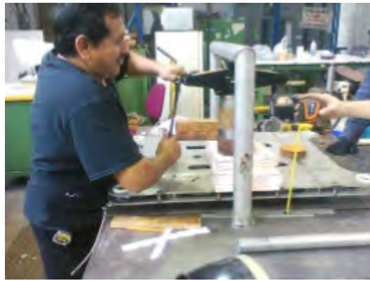
Figura 5.46: Enderezamiento de la placa de pesas.
