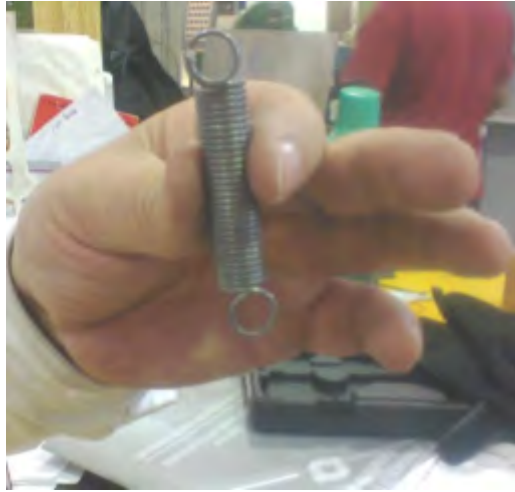
Figura 5.68: Detalle de los resortes laterales de los balancines. (Cortesía de [23])
