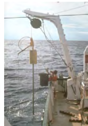
(b) Nucleador de pistón montado en una embarcación.
