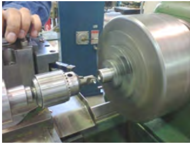
(a) Avellanado para tornillo de las guillotinas.
