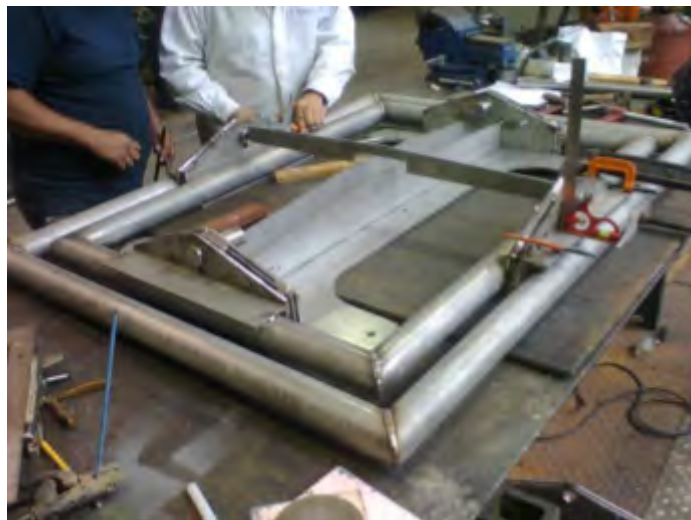
Figura 5.35: Alineado superior. (Cortesía de [23])
