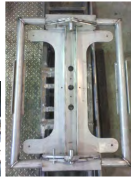
(b) Ensamble entre el nuevo marco A auxiliar y la placa superior.
