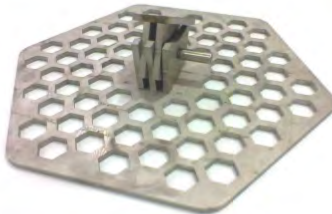
Figura 5.93: Raqueta hexagonal ventilada. (Cortesía de [23])
