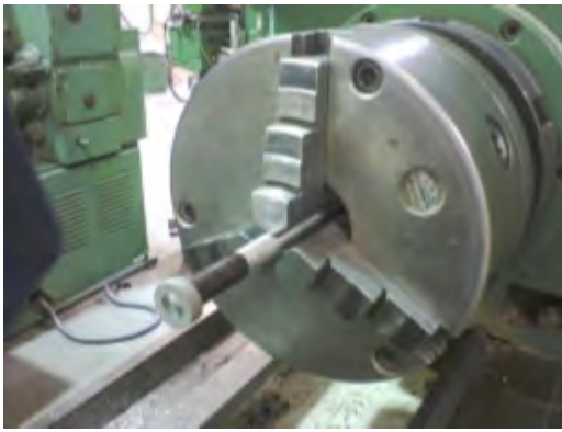
(a) Manufactura de pernos en torno.
