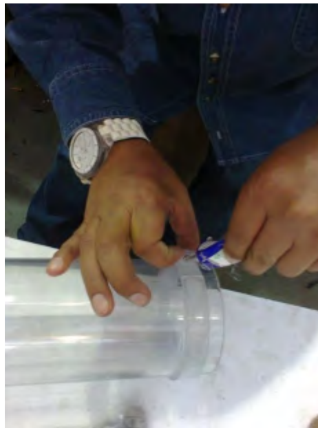
Figura 5.73: Pegado del anillo a los tubos de policarbonato.
