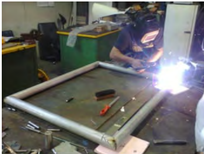
Figura 5.26: Se suelda el marco. (Cortesía de [23])
