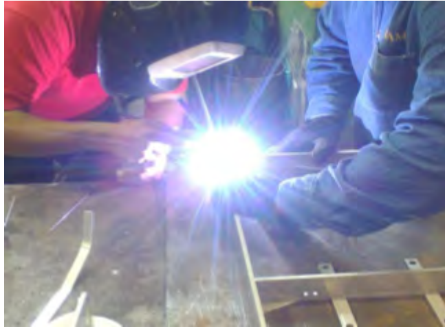
Figura 5.82: Soldadura de las placas del marco de guillotinas. (Cortesía de [23])
