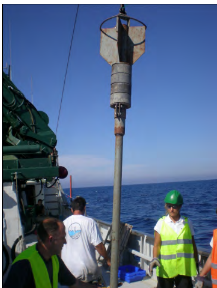
(a) Nucleador de gravedad en la embarcación.
