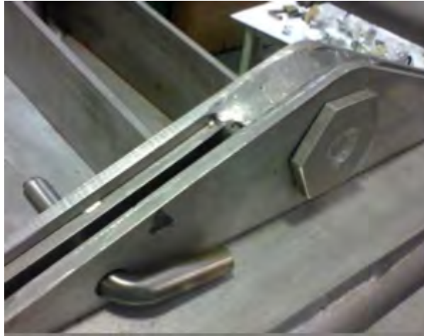
Figura 5.32: Colocación de pernos de seguridad. (Cortesía de [23])
