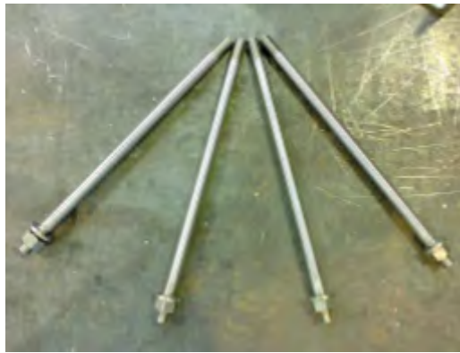
Figura 5.48: Guías y collarines para las pesas.
