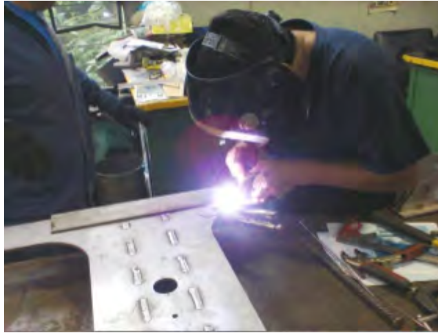
Figura 5.7: Soldado del costado. (Cortesía de [23])
