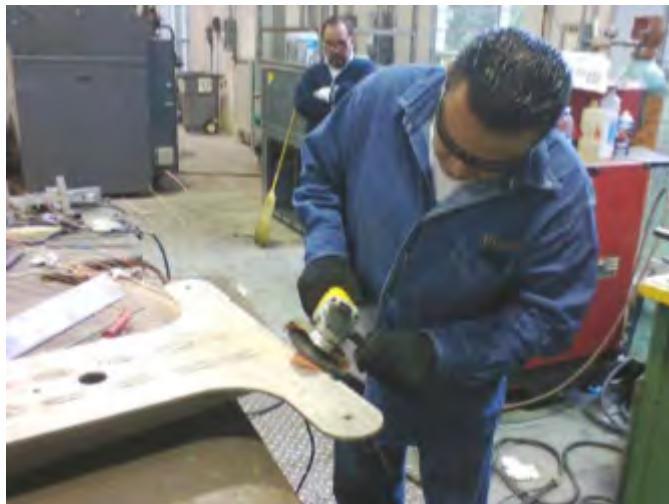
Figura 5.6: Esmerilado de la placa superior.
