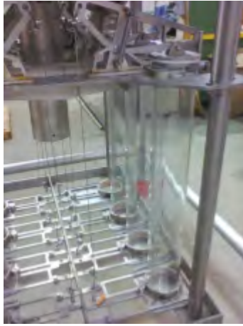
Figura 6.30: Ajuste de longitud de cables para accionar guillotinas.
