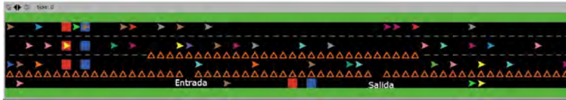
Figura 4.7: Vista de la implementación del modelo GLAI extendido para representar el cruce de la avenida Río Churubusco y la calzada de Tlalpan con una barrera. Los triángulos rellenos de colores que apuntan a la derecha son vehículos desplazándose de izquierda a derecha. Los triángulos huecos de color naranja representan los camellones que separan carriles centrales del carril auxiliar y también representan la barrera física que previene alcanzar el carril de extrema derecha (de los carriles principales) de último momento para utilizar la rampa de salida. Los cuadros rojos y azules representan el inicio y fin, respectivamente, de los sensores que se utilizan para medir densidad y flujo.
