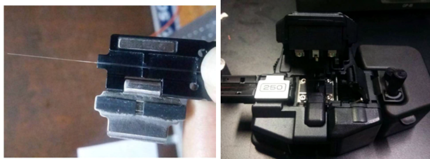
(a) Colocación en el soporte.
