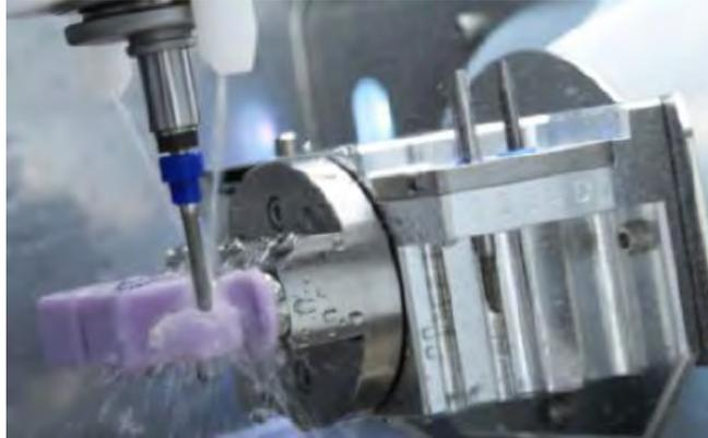
Figura 56 Fresado de la corona bajo lubricación.
