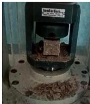
Figura 20 Prueba de compresión con máquina universal.
