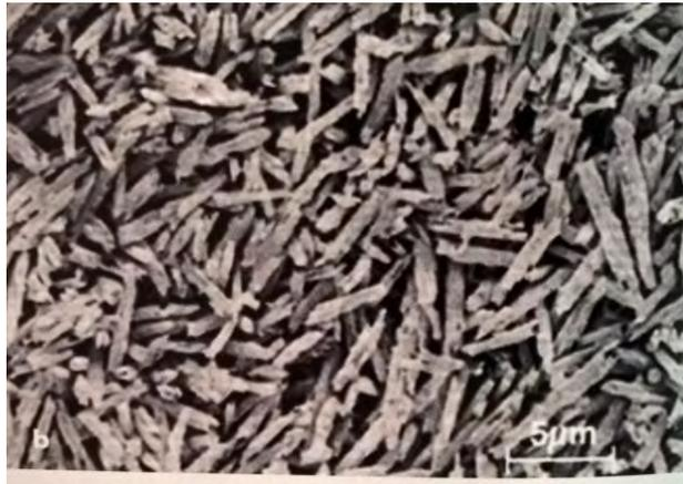
Figura 15 Disilicato de litio visto bajo microscopía electrónica de barrido 5000x. (IPS e.max CAD, Ivoclar-vivadent).
