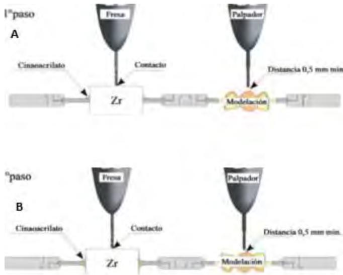
Figura 24 A) Nivelación de parte superior. B) Nivelación de la parte inferior.
