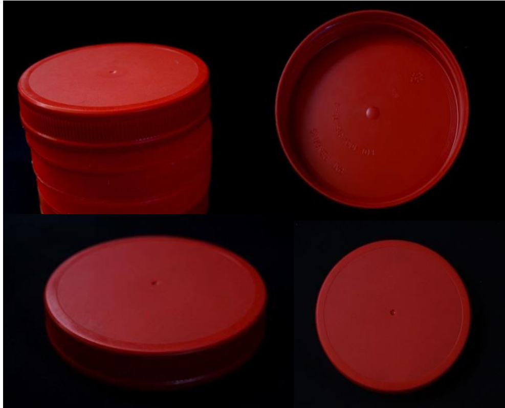
Fuente directa. Muestra de las tapas plásticas de polipropileno utilizadas como soportes de muestras.
