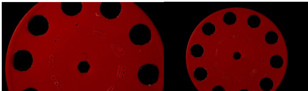
Fuente directa. Acercamiento de los orificios que soportarán las muestras. Se observa el marcaje de 1 a 10 y el orificio principal para adaptación al aparato de Tuccillo.
