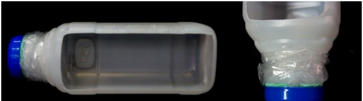
Fuente directa. Ejemplo del corte rectangular en una superficie de cada envase y el sellado hermético.
