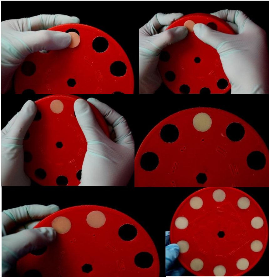
Fuente directa. Muestra de colocación de las muestras en los soportes plásticos, antes de la instalación en el aparato de Tuccillo.
