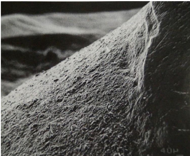
Figura 3. Fotografía al microscopio electrónico de barrido de la superficie oclusal de una restauración de resina compuesta tradicional en la zona posterior que ha sido colocada hace 5 años. La resina compuesta se ha eliminado en el margen oclusal de la derecha, y se han expuesto las partículas de relleno mayores, por lo que presenta una superficie rugosa. 2
