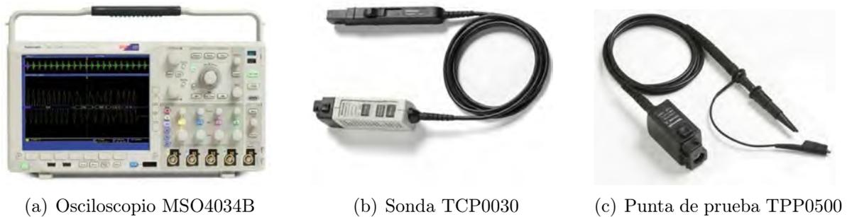
Figura 4.6: Osciloscopio y accesorios.
