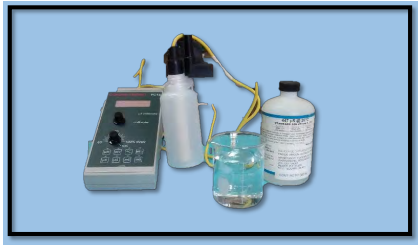
Figura 9. Potenciómetro Conductronic PC45® con celda de inmersión C1-MDIN para medición de conductividad. Fuente directa
