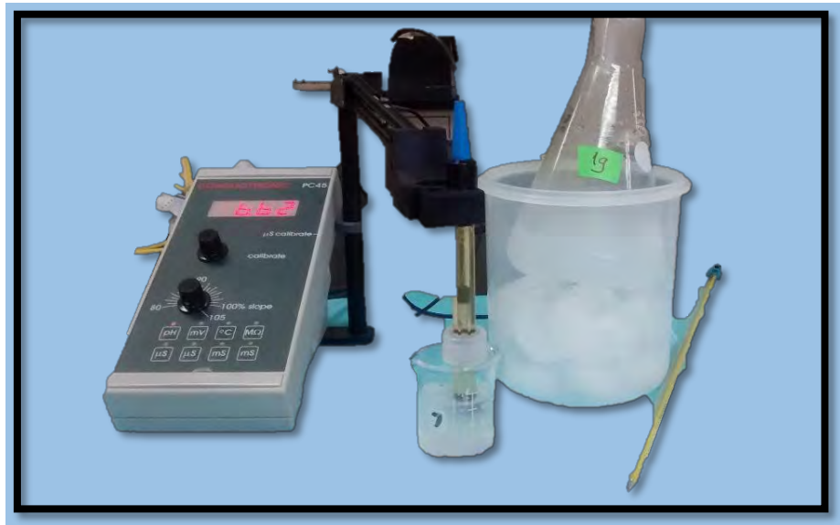
Figura 8. Potenciómetro Conductronic PC45® con electrodo para medición de pH. Fuente directa
