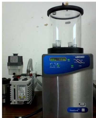
**Figura 24.** (a) cantidades volumétricas de la solución de nanopartículas para la preparación de los electrocatalizadores y (b) liofilizadora Freezezone 2.5.
