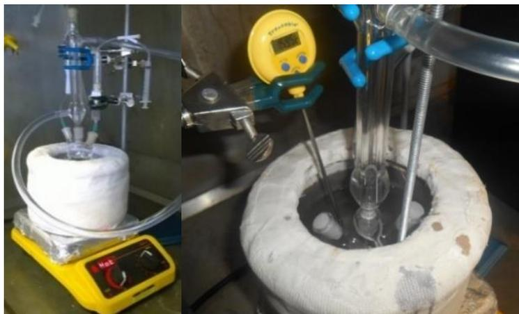
**Figura 23.** Equipo para sintetizar nanopartículas por reducción química en medio orgánico.
