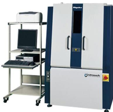
*Figura 27. Difractómetro de rayos-X, Rigaku Ultima IV.*
