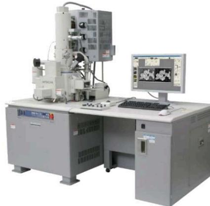
*Figura 21. Microscopio electrónico de barrido, HITACHI SU8230.*
