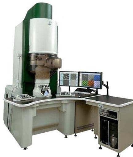
**Figura 29.** Microscopio electrónico de transmisión, Jeol ARM-200F.
