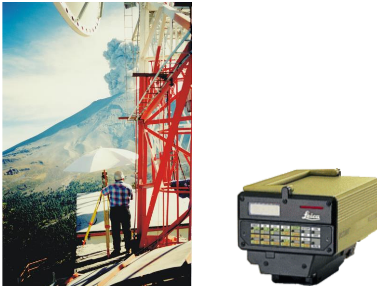
Figura 48. Mediciones con EDM (Leica DI3000S) desde Tlamacas en el flanco norte del volcán Popocatepetl. A la derecha distanciómetro Leica DI3000S
