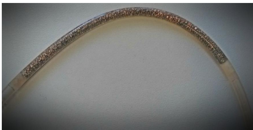
Figura 9. Columna de cadmio cuperizado empacada en tubo de Tygon®
