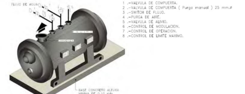
Detalle Tipo para Conexión a Unidad Generadora de Agua Caliente (Caldera)
