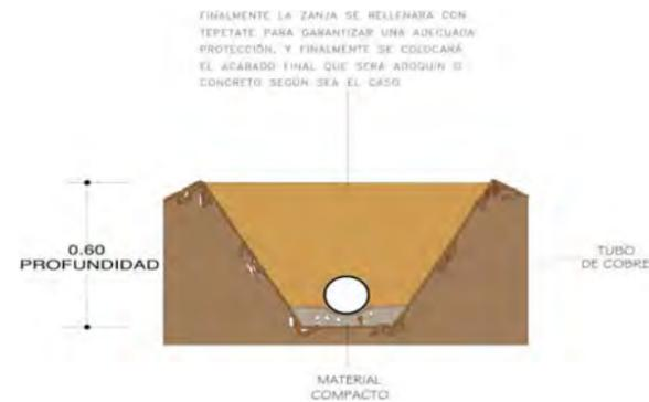
Detalle de Zanja para Tendido de Tubo Hidráulico
