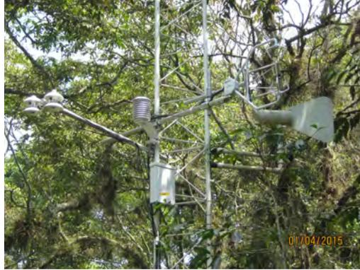
Figura 1.3: Equipo instalado por arriba del estrato de los cafetos. En la parte central de la foto: sensor  $T/RH$  protegido contra la radiación. En la parte izquierda de la foto: radiómetro neto. En la parte derecha de la foto: sistema de eddy covarianza.
