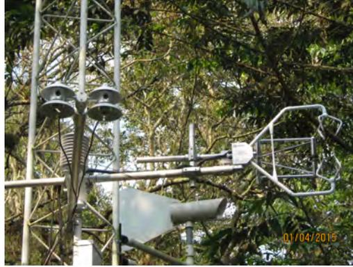
Figura 1.2: Sistema de eddy covarianza para medir los flujos turbulentos de calor sensible y latente al nivel del sotobosque (3.7 m). El anemómetro sónico, el higrómetro de respuesta rápida y el termopar de bulbo seco se encuentran orientados al sureste.
