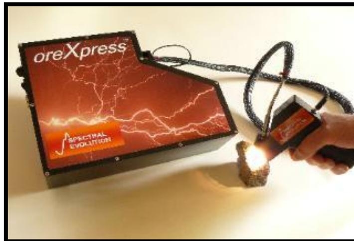
**Figura 3.23.**Equipo Infrarrojo de onda corta
