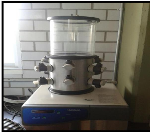
**Figura 3.10.** Equipo de liofilización LABCONCO del laboratorio de Edafología Ambiental, UNAM.
