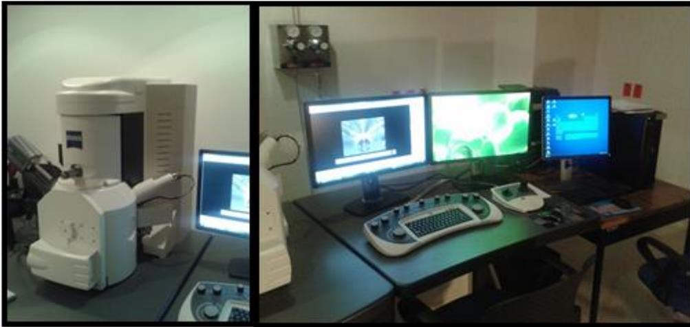
**Figura 3.9.**Microscopio Electrónico de Barrido del Instituto de Geología, UNAM.
