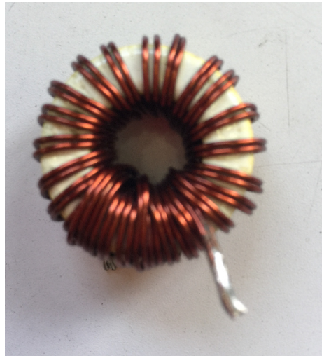
Figura 4. 4 Inductor de salida de la fuente conmutada.
