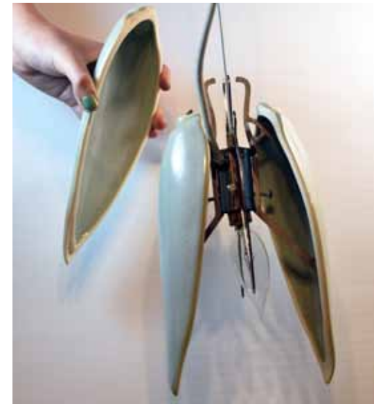
Colocación de las hojas sobre la estructura del luminario.
