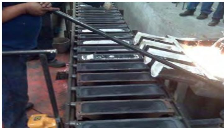
Figura 1.10 Colada de lingotes de aluminio por gravedad
