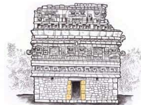
Fig. 6.- Imagen parcial de una de las fachadas del Edificio del Conjunto de las Monjas en Chichenitzá. Podemos observar como las jambas de mampostería soportan el dintel.
