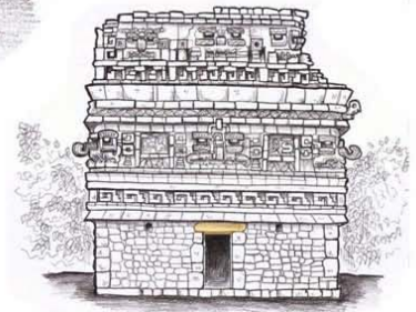
Fig. 3.- Imagen parcial una de las fachadas del Edificio del Conunto de las Monjas en Chichenitzá. Podemos observar como el Dintel cierra o concluye el vano de la puerta en su parte superior.
