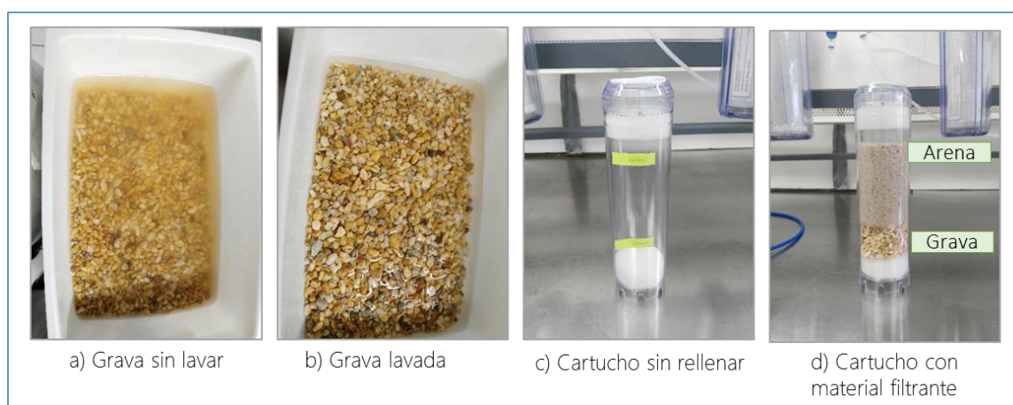
FIGURA 11 PREPARACIÓN DEL MATERIAL Y LLENADO DE FILTRO DE ARENA
