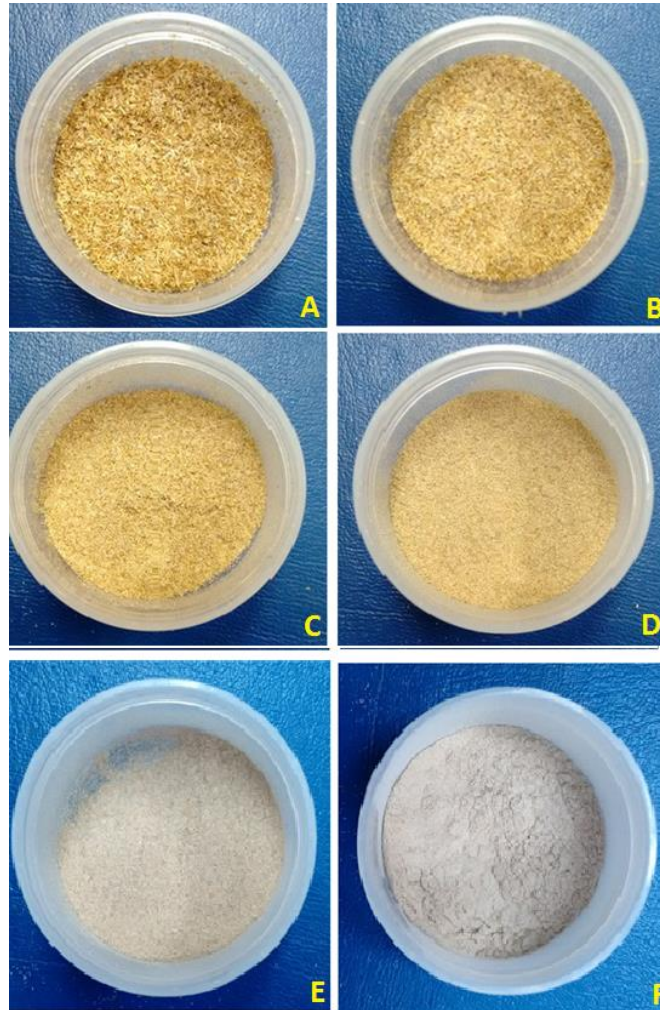
Figura 4.8 A) Malla #40, B) Malla #50, C) Malla #70, D) Malla #100, E) Malla #140, F) Malla #200.
