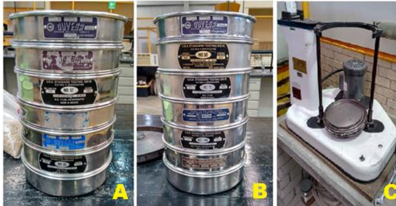
Figura 4.6 A) Tamices de cribado burdo (#8, #10, #12, #14, #30, #35) B) Tamices de cribado fino (#40, #50, #70, #100, #140, #200, #325, #400) bajo la norma ASTM E11-09, ISO 565 3310-1, C) Agitadora industrial RO-TAP.
