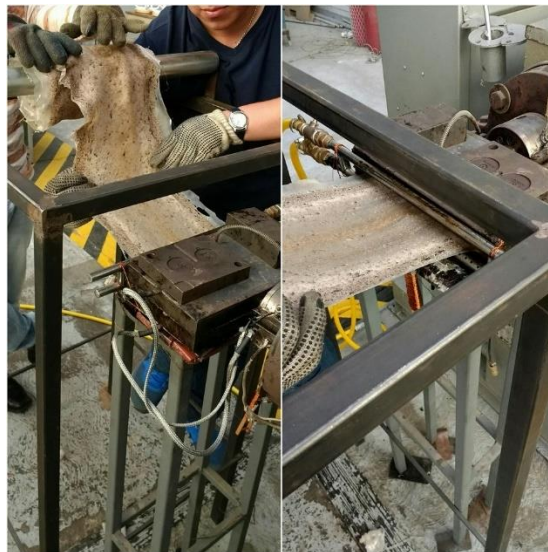
Figura 4.16 Salida de la lámina del dado de extrusión.
