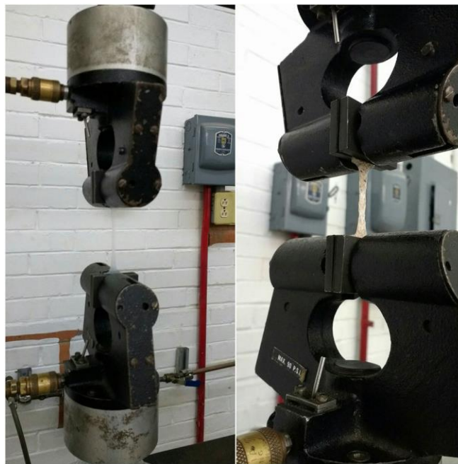
Figura 4.19 Ensayos de tensión a las diferentes probetas
