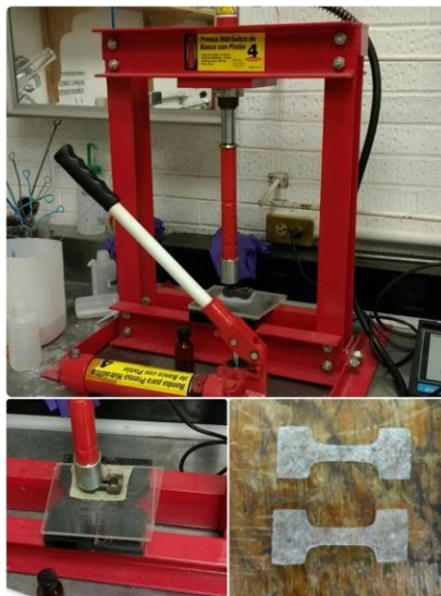
Figura 4.18 Proceso de corte de probetas de tensión.
