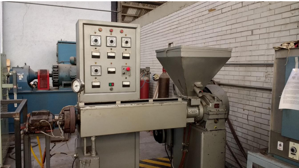
Figura 4.13 Máquina de extrusión del Laboratorio de Procesamiento de Plásticos.
